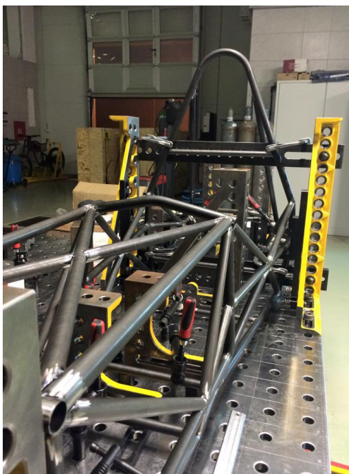
Slika 2.9. Nosiva konstrukcija na zavarivačkom stolu
