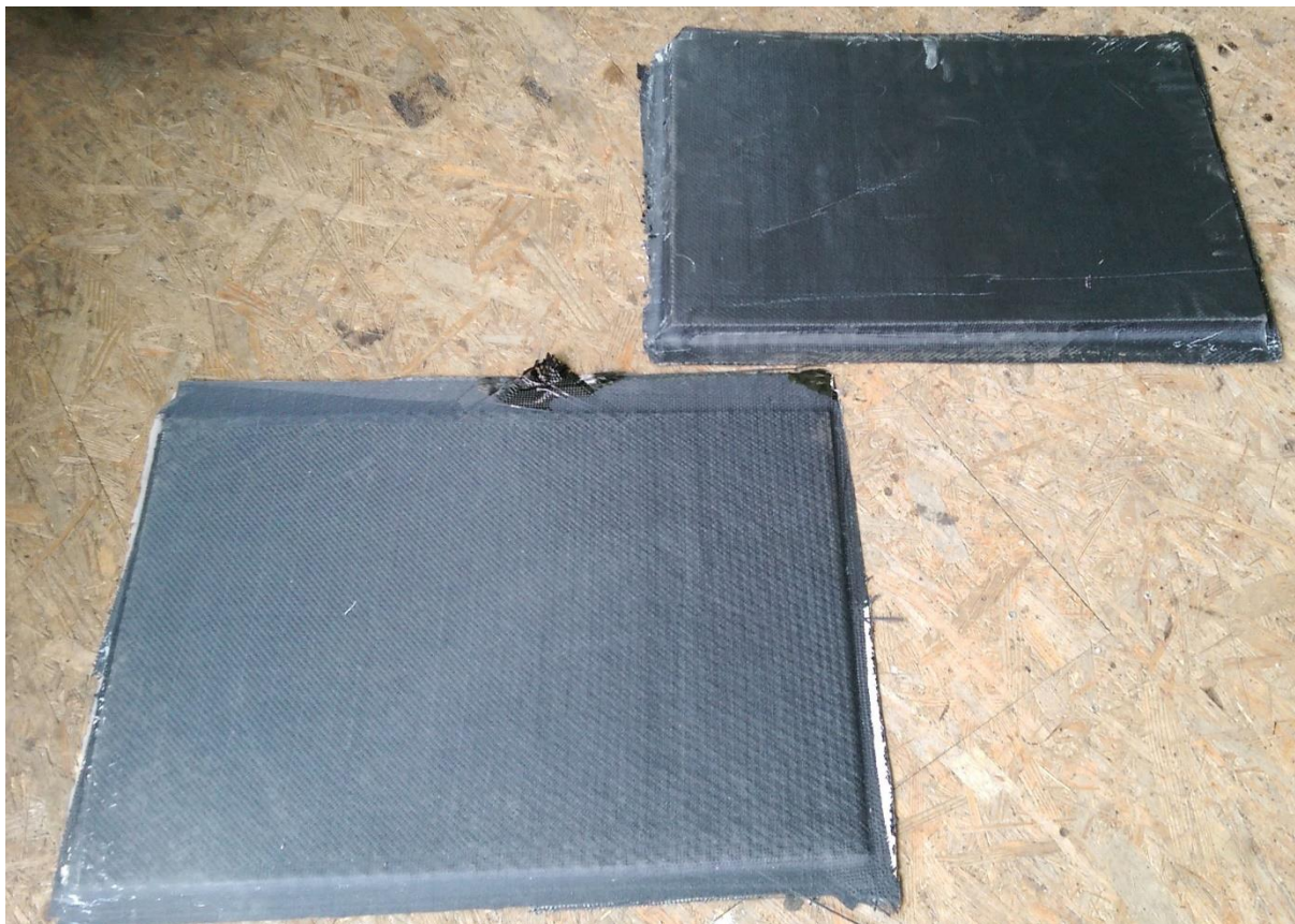
Slika 5.13. Kompozitni sendvič paneli s viškom materijala na rubovima
