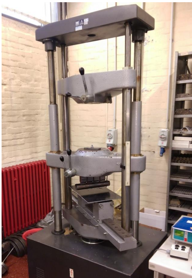
Slika 5.17. Postav spreman za ispitivanje savijanja
