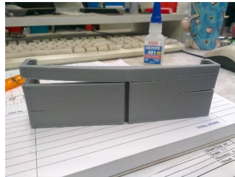
Slika 3.5. Premalo kvašenje između slojeva [13]
