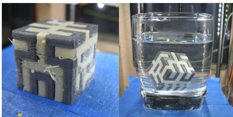
Slika 2.10. Tvorevina s potpornom strukturom od poli(vinil-alkohola) – PVAL [14]
