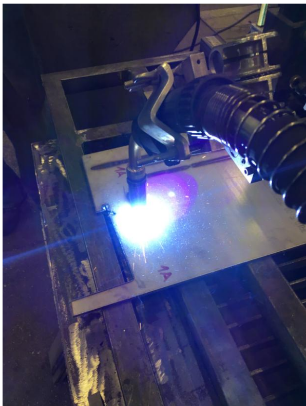
Slika 22 Navarivanje - uzorak 1A (CBT)
