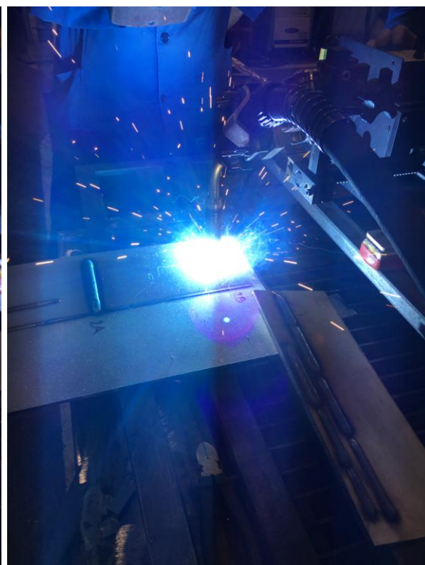
Slika 25 Navarivanje - uzorak 2B (impulsno)
