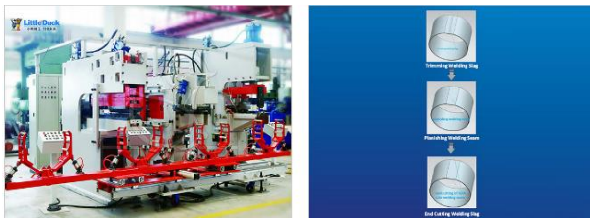
Slika 4.4 Podrezivanje, poravnavanje, obrezivanje [17]
