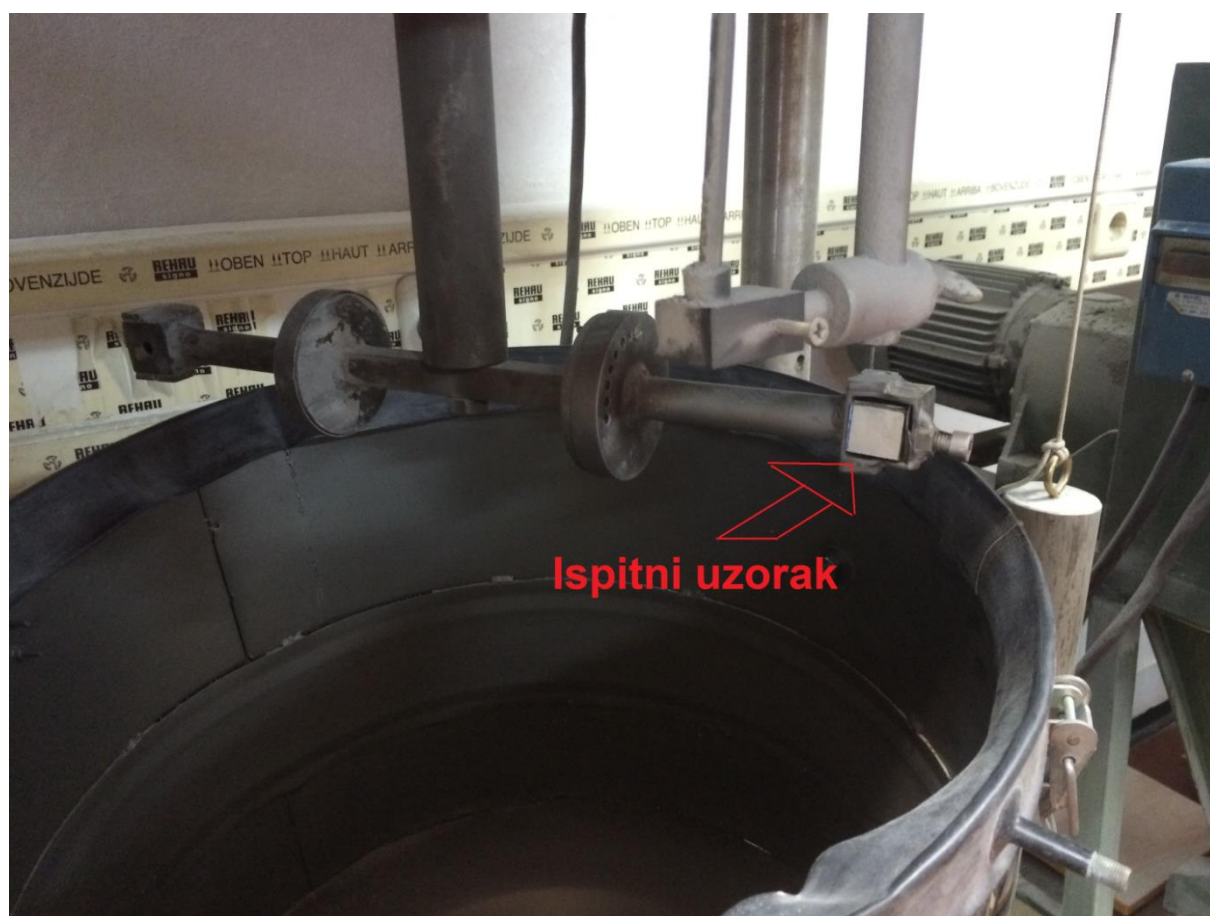
Slika 7.8 položaj uzorka pod kutem od 90^\circ u držaču prilikom ispitivanja otpornosti na erozijsko trošenje
