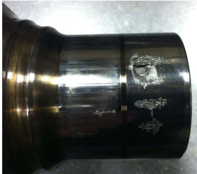
Slika 22. Oštećenje zbog prevelikog operativnog kuta među vratilima [17]
