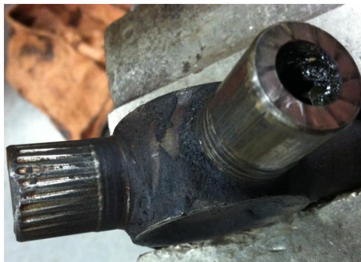
Slika 21. Utiskivanje valjnih tijela u rukavac [17]
