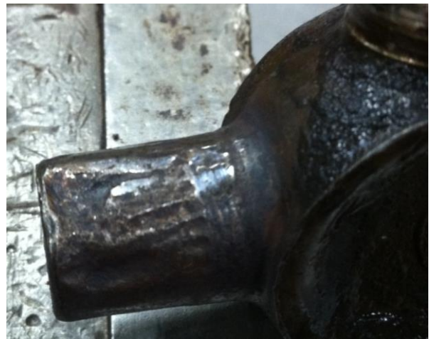
Slika 20. Oštećenje uslijed nedostatka maziva [17]
