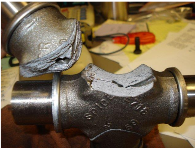
Slika 19. Lom uslijed preopterećenja [17]
