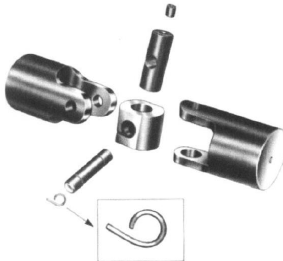
Slika 12. Jednostavni kardanski zglob [12]
