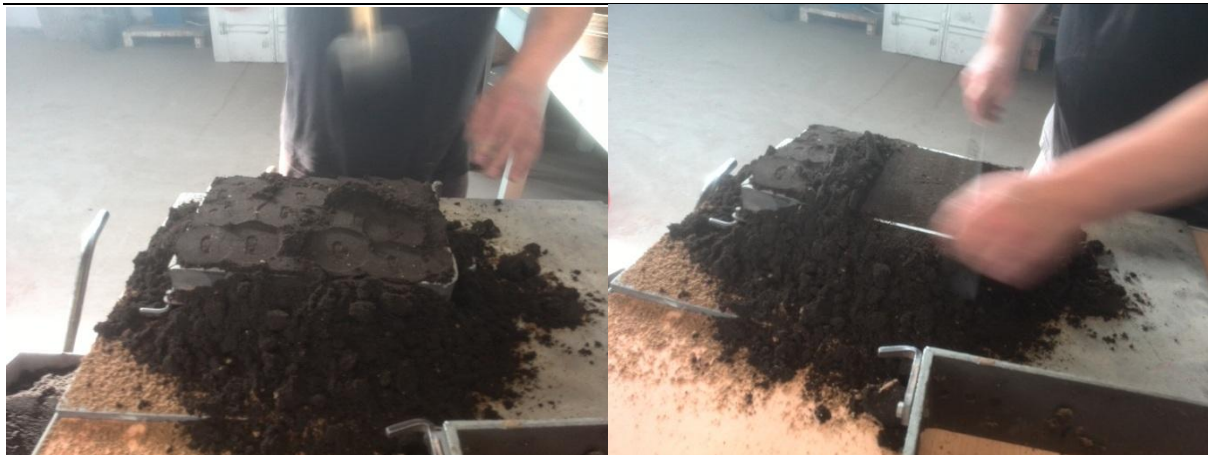
Slika 55. Sabijanje i poravnavanje punidbene kalupne mješavine donjaka
