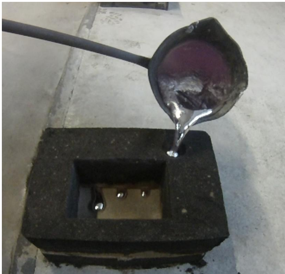
Slika 70. Lijevanje u sustav 1:2:2 1.3ds
