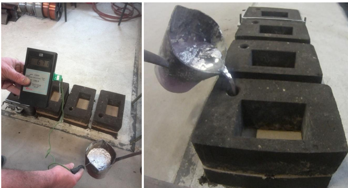
Slika 67. Mjerenje temperature kod kalupa i ulijevanje
