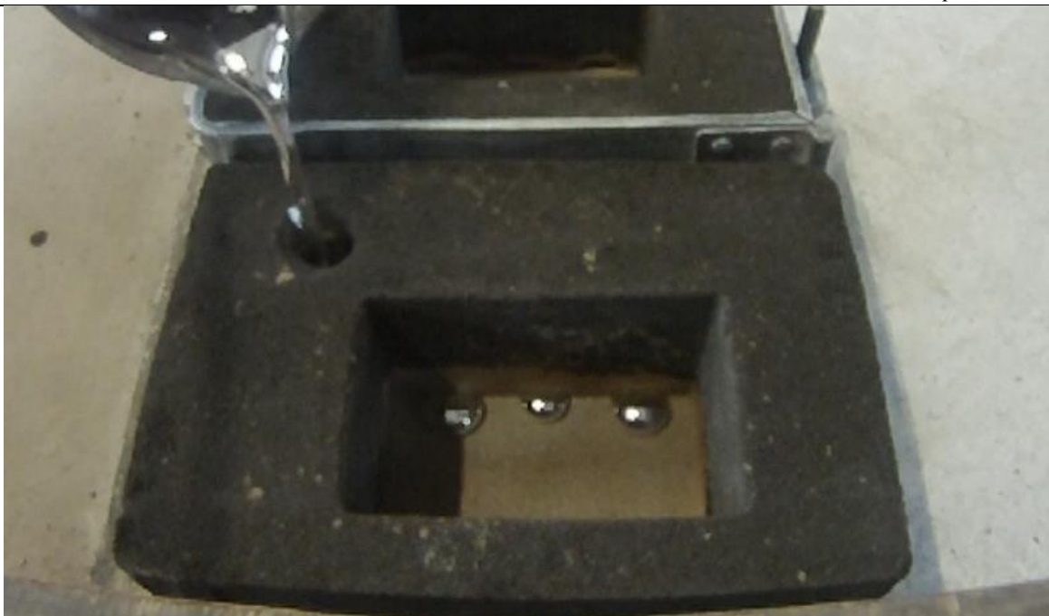
Slika 71. Lijevanje u sustav 1:4:4
