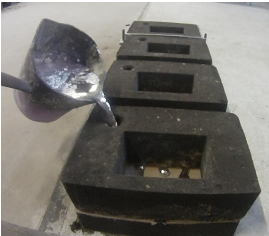
Slika 69. Lijevanje u sustav 1:2:2
