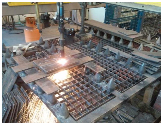
Slika 49. Plinsko rezanje traka
