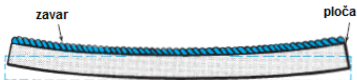
Slika 8. Shematski prikaz savijanja [7]
