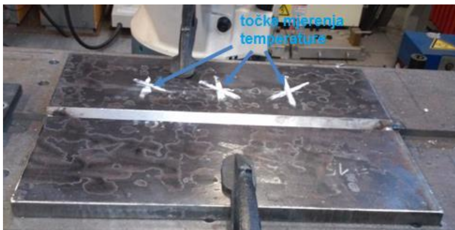
Slika 39. Pripremljeni spoj 2 za zavarivanje
