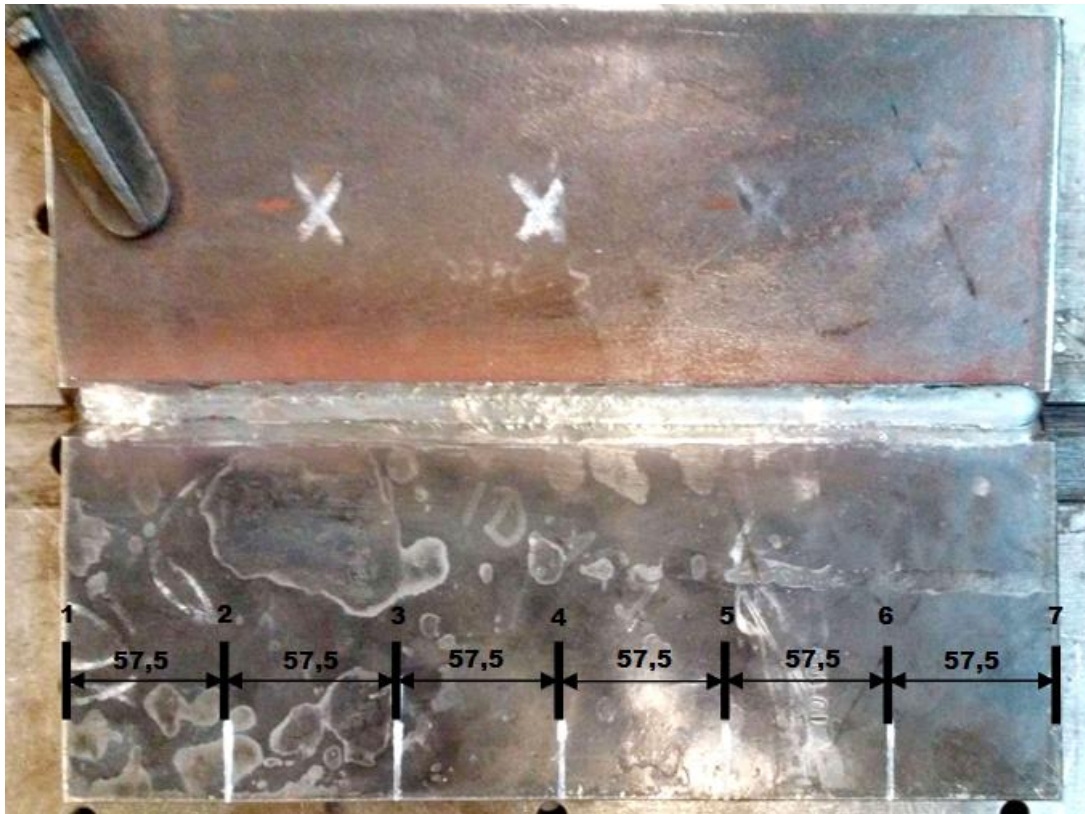
Slika 47. Točke mjerenja deformacija
