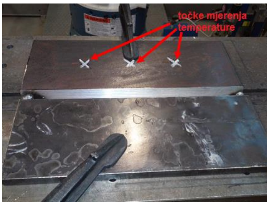
Slika 35. Spoj 1 pripremljen za zavarivanje
