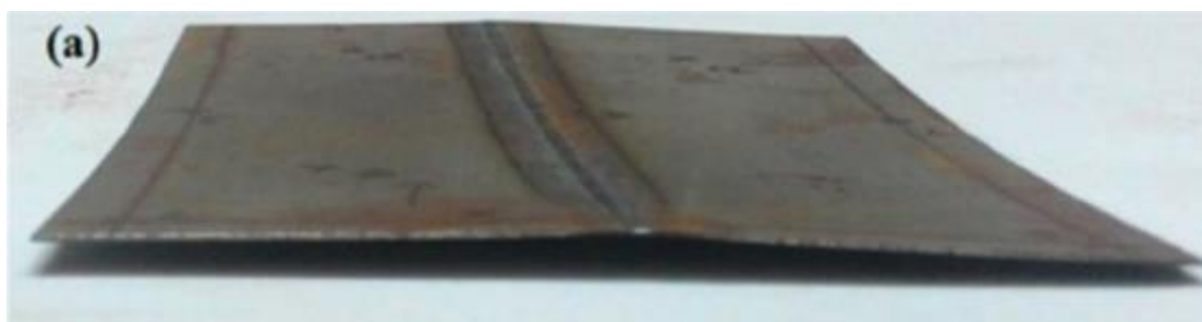
Slika 18. Realni primjer iskrivljenja [11]
