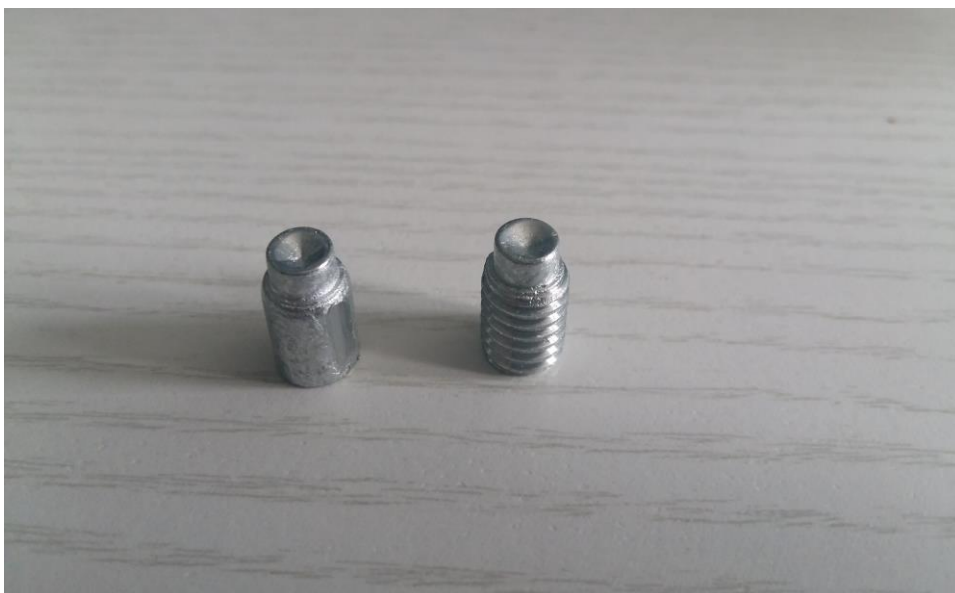
Slika 11. Dio C prije i nakon rezanja navoja
