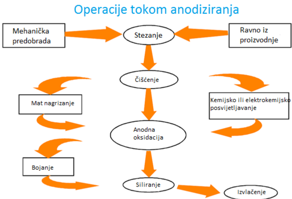
Slika 20. Operacije pri anodiziranju aluminija [32]
