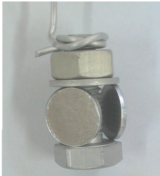
Slika 24. Uzorci stegnuti na vijku
