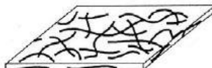
Slika 6 (a i b): Kompozit s usmjerenim vlaknima (a), kompozit sa slobodnim vlaknima (b) [1]
