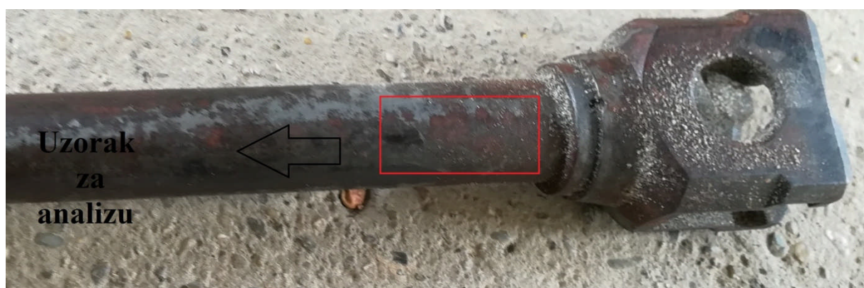
Slika 8.4. Uzimanje uzoraka cijevi lovačkog oružja
