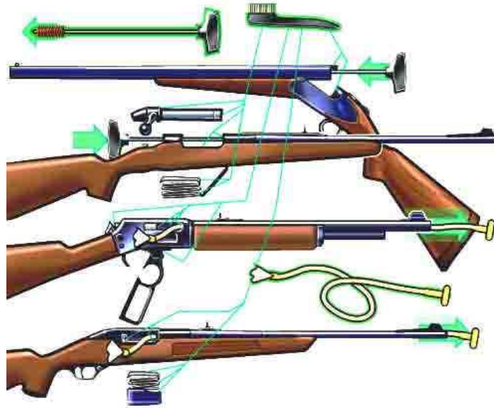
Slika 7.2. Prikaz osnovnog čišćenja lovačke puške [14]
