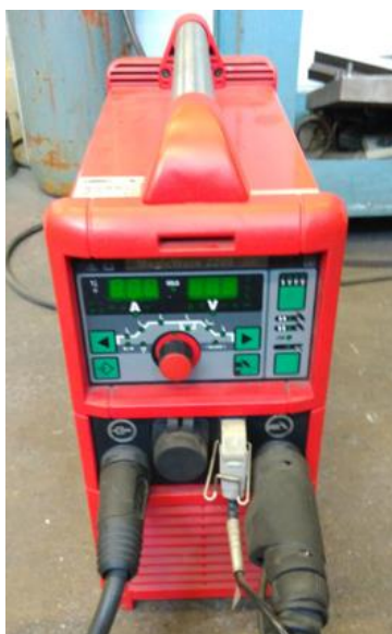
Slika 21. Uređaj za TIG zavarivanje Fronius MagicWave 2200 Job G/F
