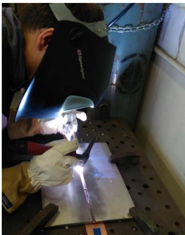
Slika 12. TIG zavarivanje Hastelloy C-22 legure
