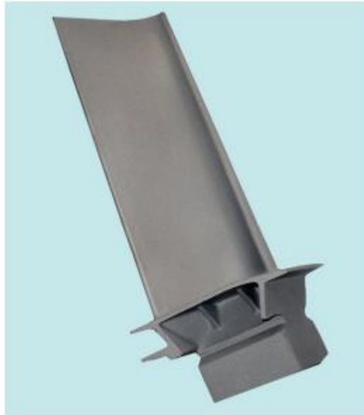
Slika 19. Lopatica visokotlačne turbine mlaznog motora [27]
