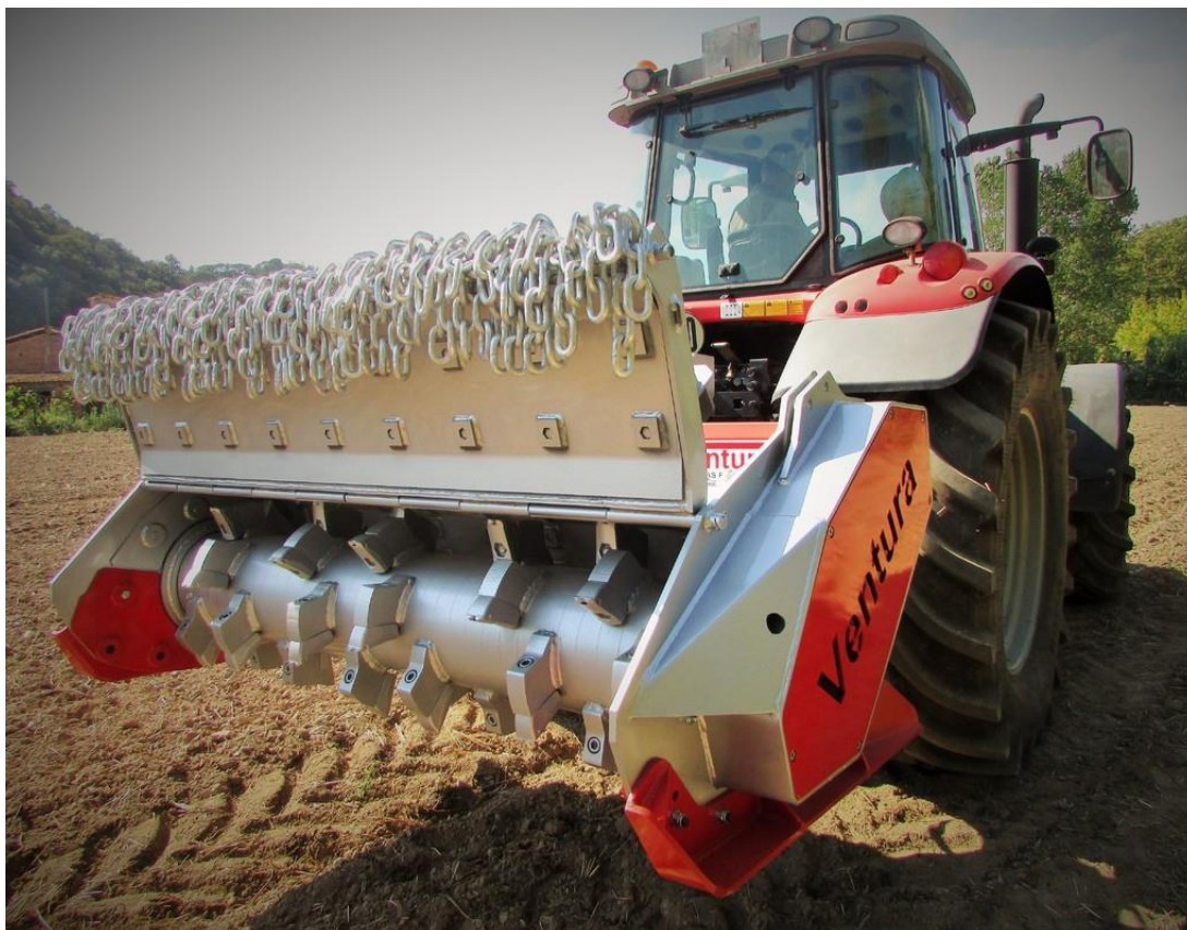
Slika 18. Radni bubanj Ventura Arkansas
