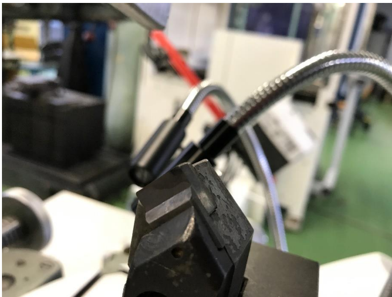
Slika 44. Rezna pločica pričvršćena u držaču
