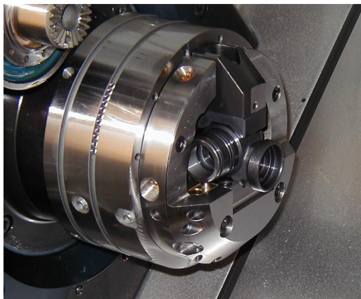
Slika 11. Prikaz specijalne stezne glave [7]
