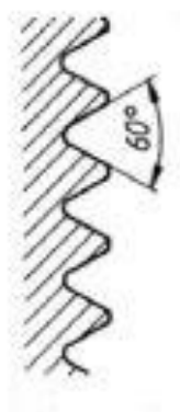
Slika 41. Prikaz finog metričkog navoja [29]
