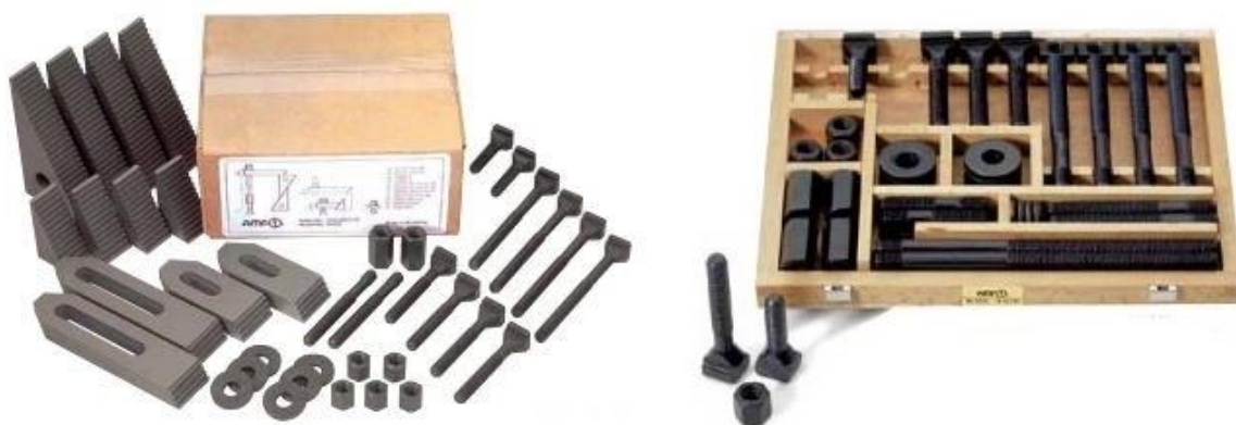
Slika 16. Razni pribor za stezanje obradaka [9]
