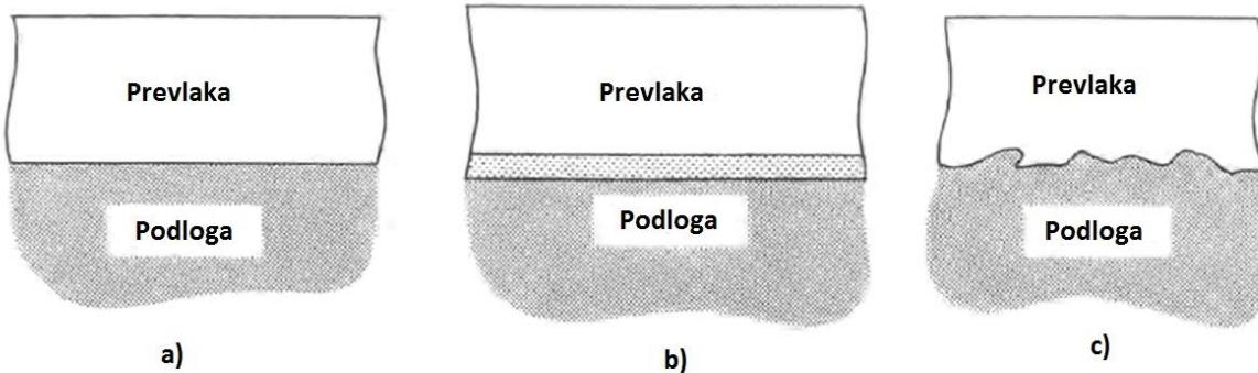
**Slika 9: Načini povezivanja prevlake i podloge [18]**
