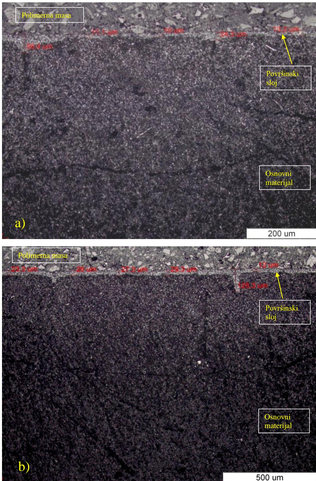
Slika 20. Usporedni prikaz polaznog i boriranog stanja snimljen svjetlosnim mikroskopom:
