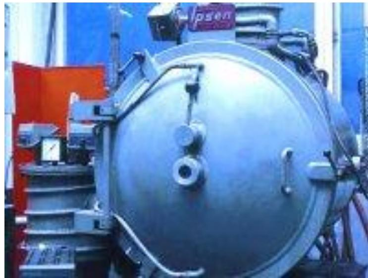
Slika 13. Vakuumska peć Laboratorija za toplinsku obradu [28]
