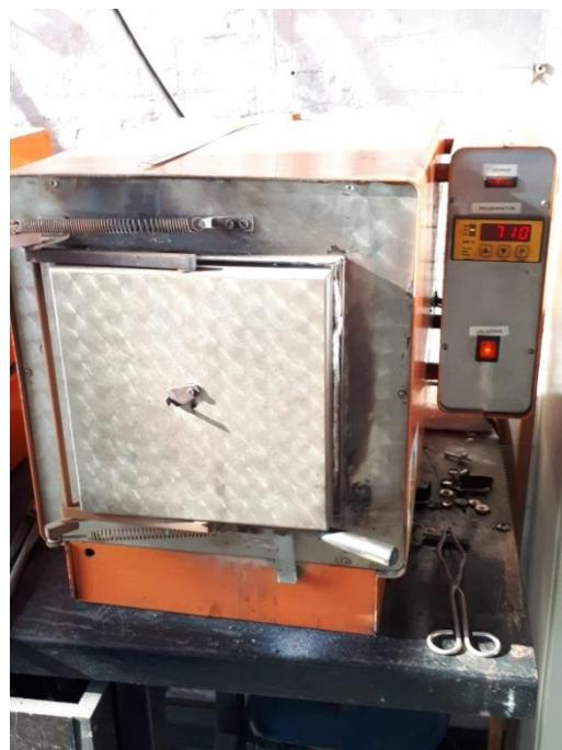
Slika 15. Peć u kojoj se vršilo boriranje
