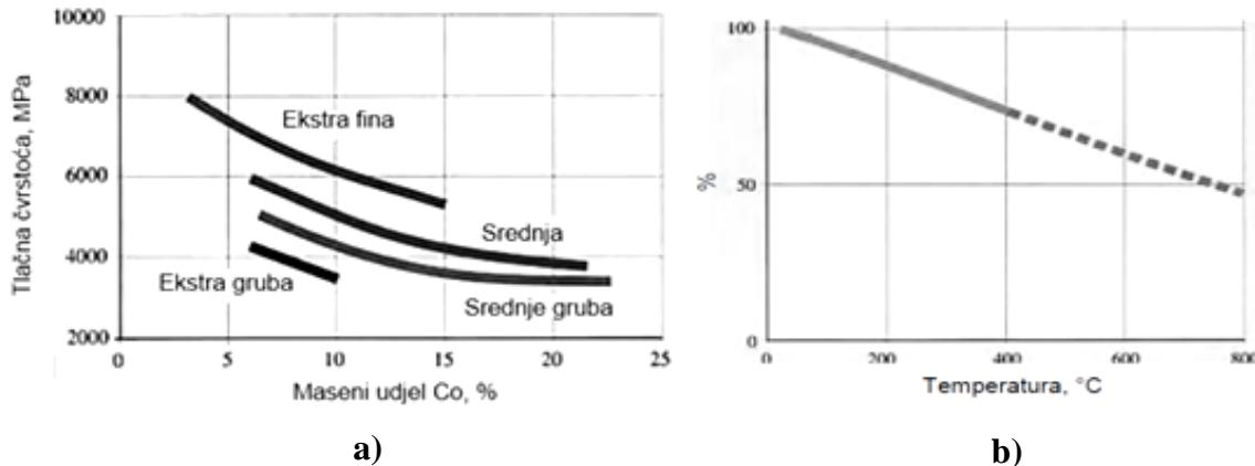
Slika 4. Tlačna čvrstoća tvrdih metala [9]
