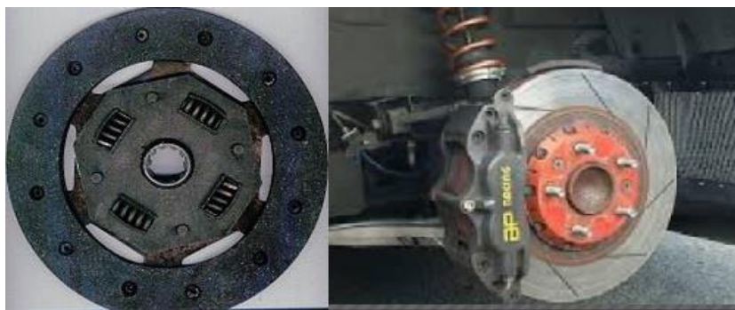
Sl. 2 Primjeri korisnog trenja; spojka i disk kočnice [4]
