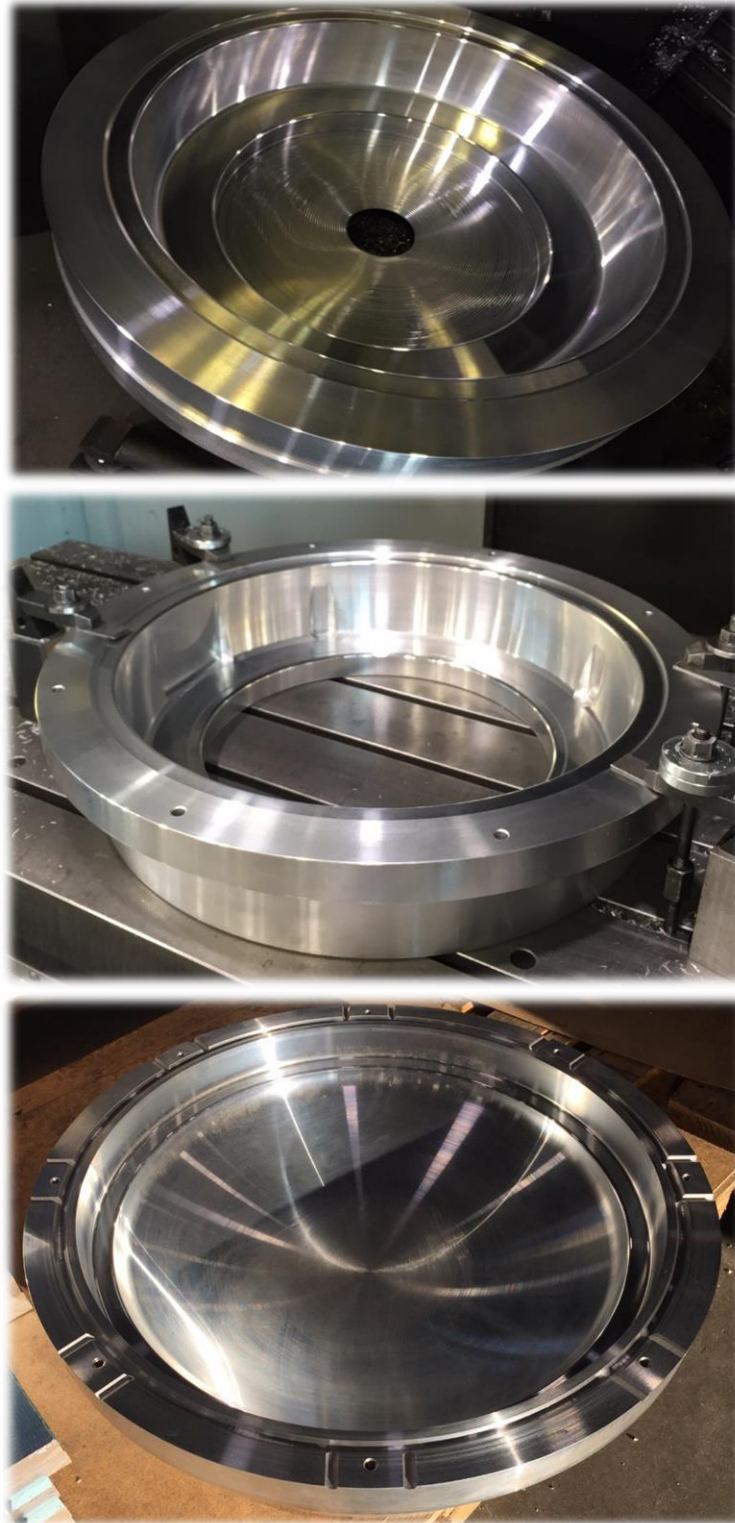
Slika 4.12 Tokarenje i glodanje kalupne šupljine
