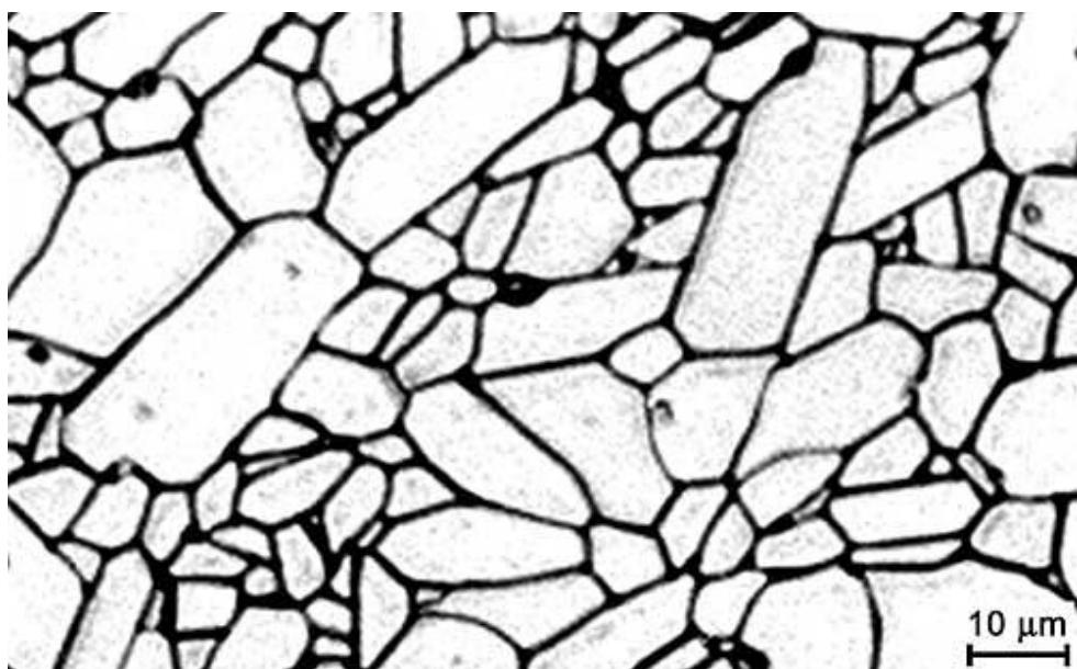
Slika 2. Mikrostruktura 99,7 %-tne aluminijeve oksidne keramike [5]
