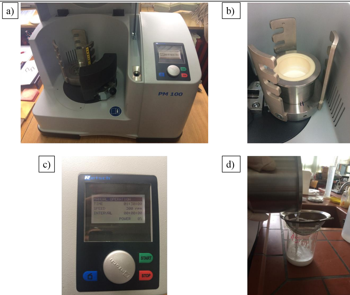
Slika 18. Homogenizacija suspenzija: (a) planetarni kuglični mlin Retsch PM 100; (b) unutrašnjost mlina s posudom za homogenizaciju; (c) sučelje mlina; (d) filtracija suspenzije
