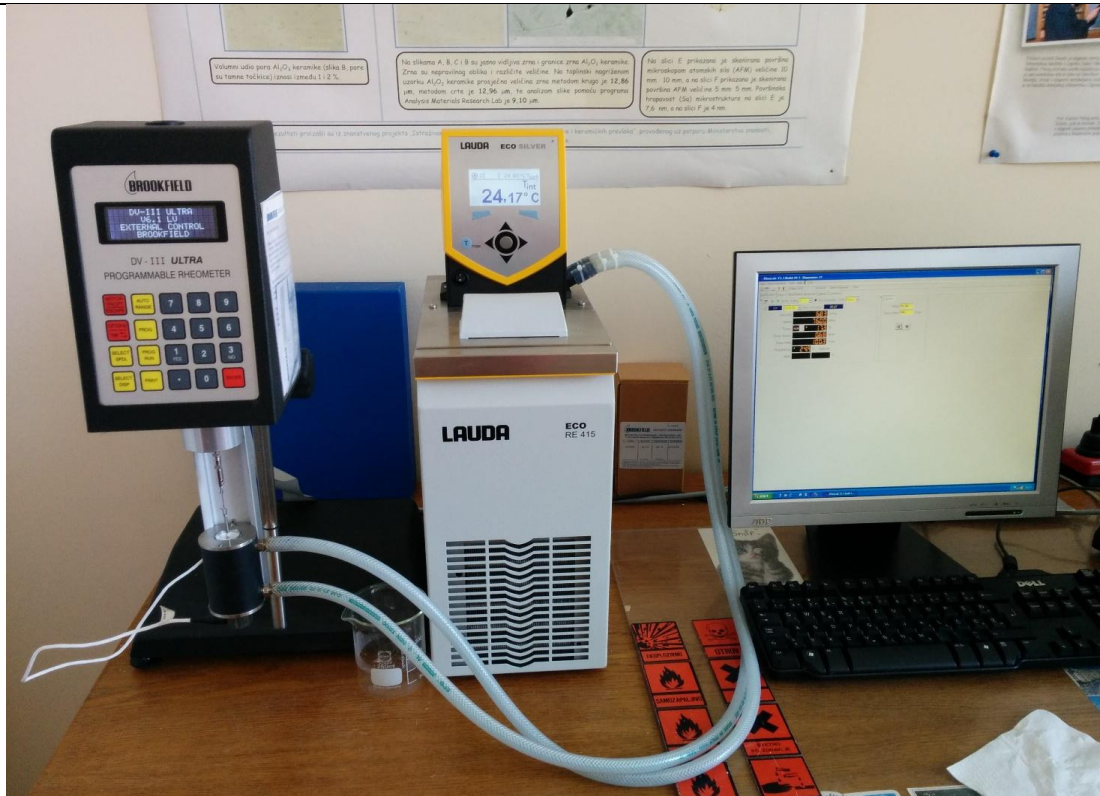
Slika 20. Rotacijski viskozimetar Brookfield DV-III Ultra [9]
