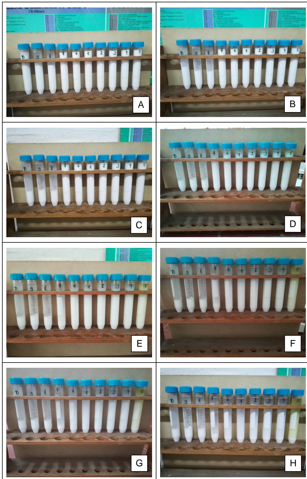
Slika 23. Graduirane epruvete u kojima je 20 %-tna Al_2O_3 vodena suspenzija stabilizirana s 0,1 % Tirona nakon (A) 15 minuta, (B) 1 sat, (C) 2 sata, (D) 24 sata, (E) 48 sati, (F) 72 sata, (G) 96 sati i (H) 168 sati sedimentacije.
