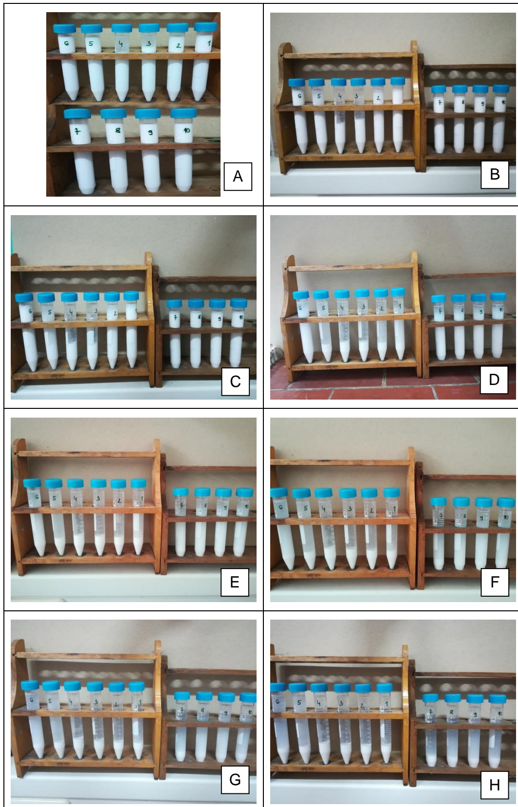
Slika 24. Graduirane epruvete u kojima je 20 %-tna \text{Al}_2\text{O}_3 vodena suspenzija stabilizirana s 0,1 % limunske kiseline nakon (A) 15 minuta, (B) 1 sat, (C) 2 sata, (D) 24 sata, (E) 48 sati, (F) 72 sata, (G) 96 sati i (H) 168 sati sedimentacije.
