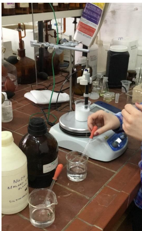
Slika 22. Podešavanje pH vrijednosti 20 %-tne \text{Al}_2\text{O}_3 vodene suspenzije dodatkom otopine HCl koncentracije 1 mol/l
