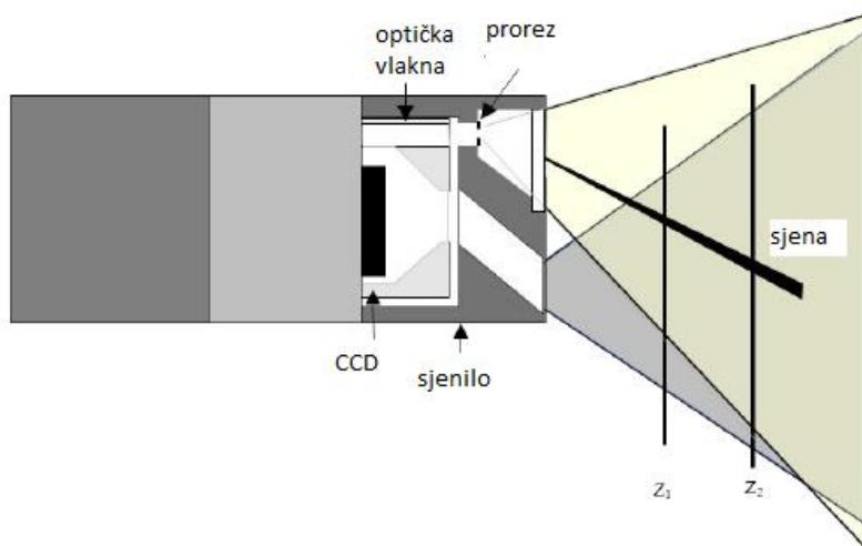
Slika 5. Prikaz principa rada mjerena metodom sjenčanja [6]
