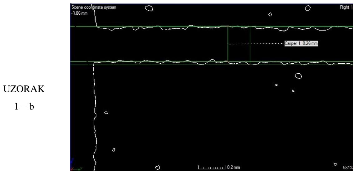
Slika 48. Očitavanje širine oštećenja iz Y-Z ravnine, [mm]
