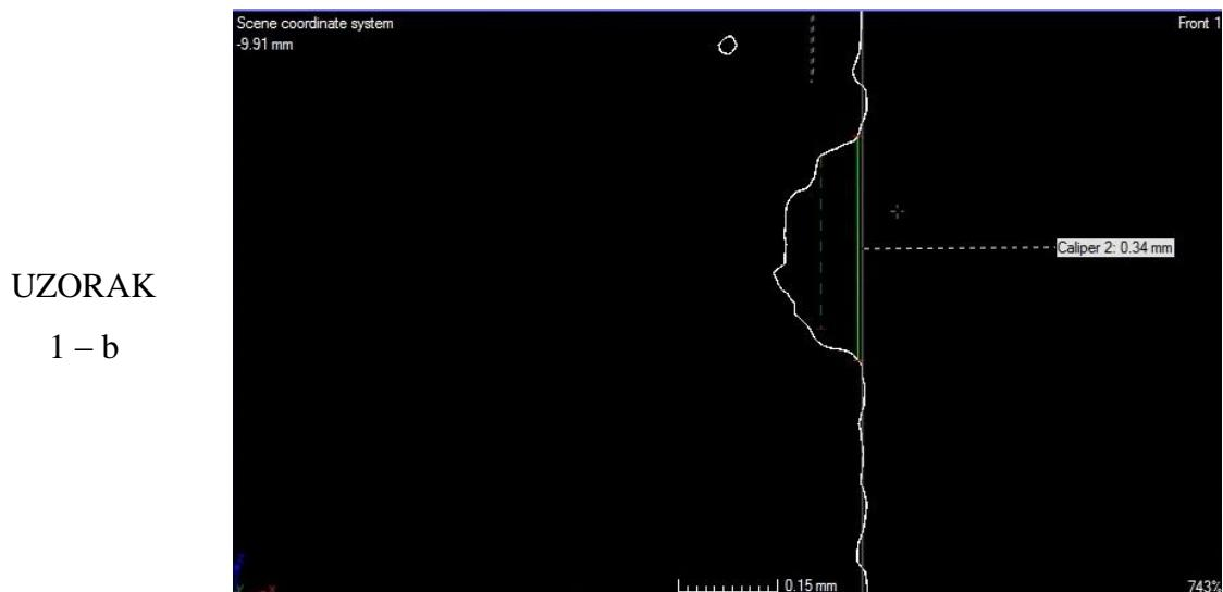
Slika 49. Očitavanje širine oštećenja iz X-Y ravnine, [mm]
