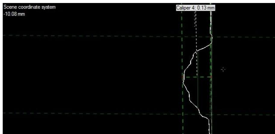
Slika 50. Očitavanje dubine oštećenja iz X-Y ravnine, [mm]
