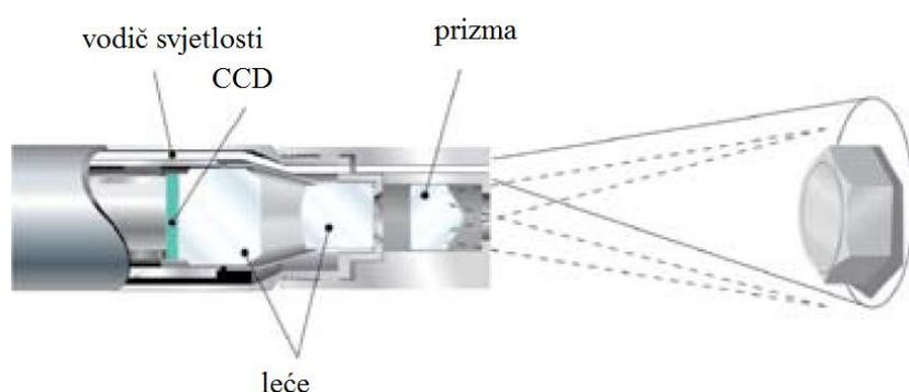
Slika 9. Prikaz projiciranja svijetla tokom stereo metoda mjerena [8]
