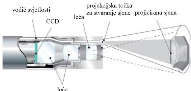
Slika 6. Prikaz projiciranja sjene tokom mjerena metodom sjenčanja [8]
