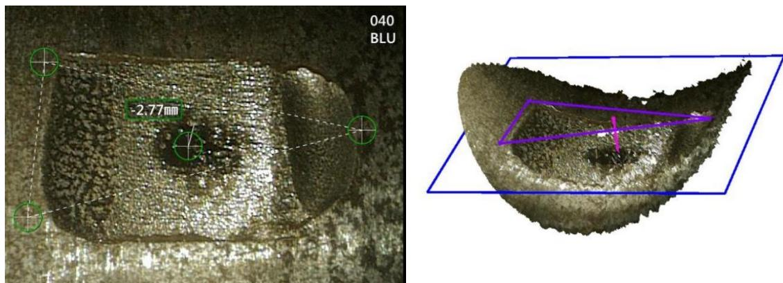
Slika 22. Očitavanje dubine oštećenja u odnosu na zadanu ravninu, dok je u 3D vidljivo da je oštećenje uleknuuto [16]
