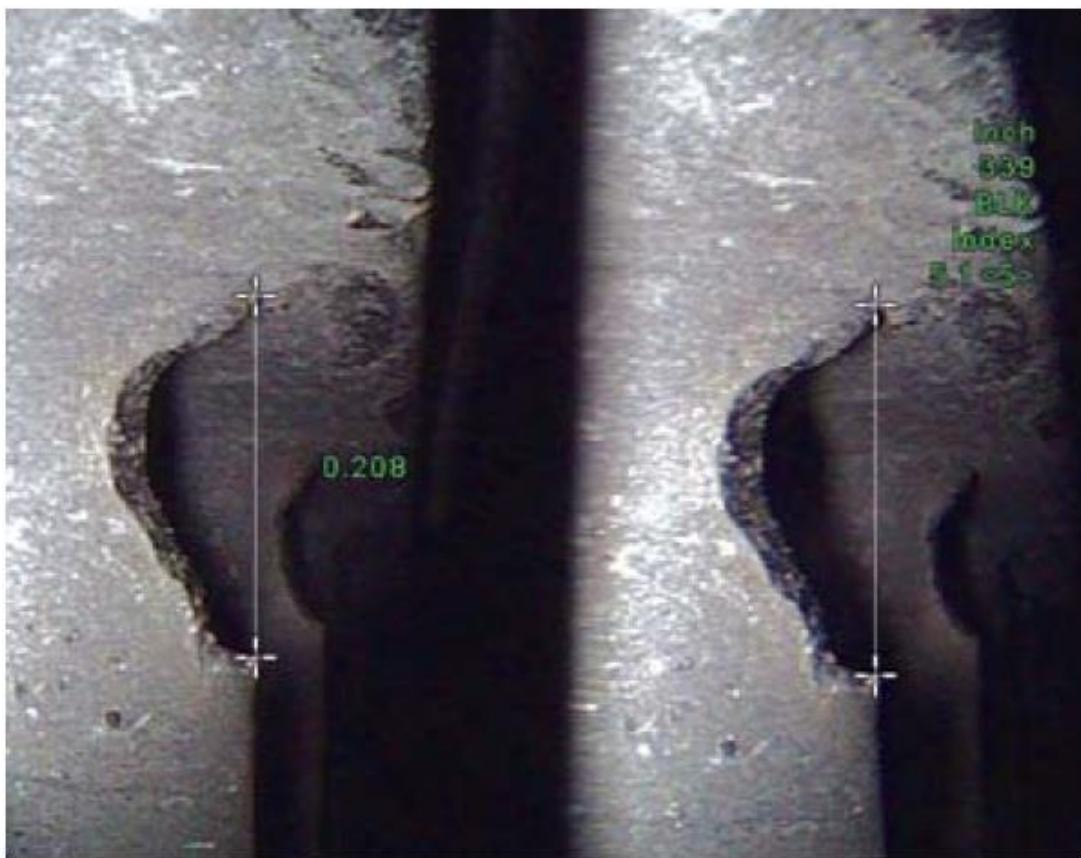
Slika 10. Primjer očitavanja dužine oštećenja primjenom stereo metode mjerena [8]
