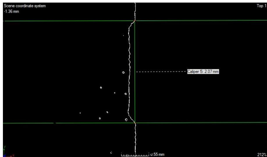
Slika 46. Očitavanje širine oštećenja iz X-Y ravnine, [mm]
