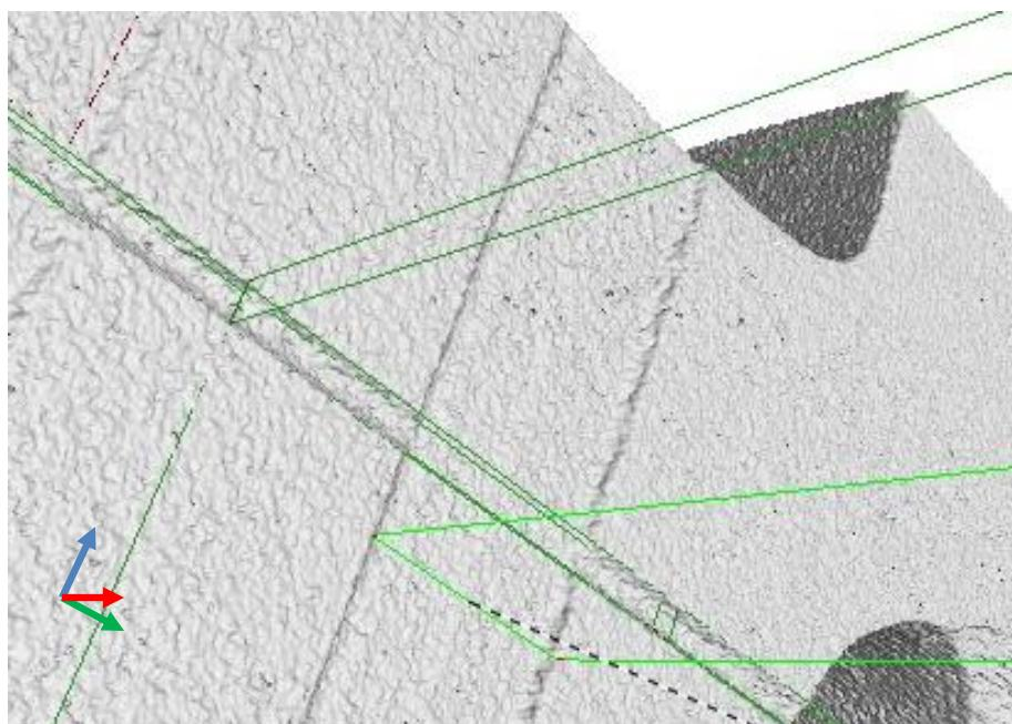
Slika 45. Prikaz rendgenske snimke uzorka i označavanja oštećenja prije
