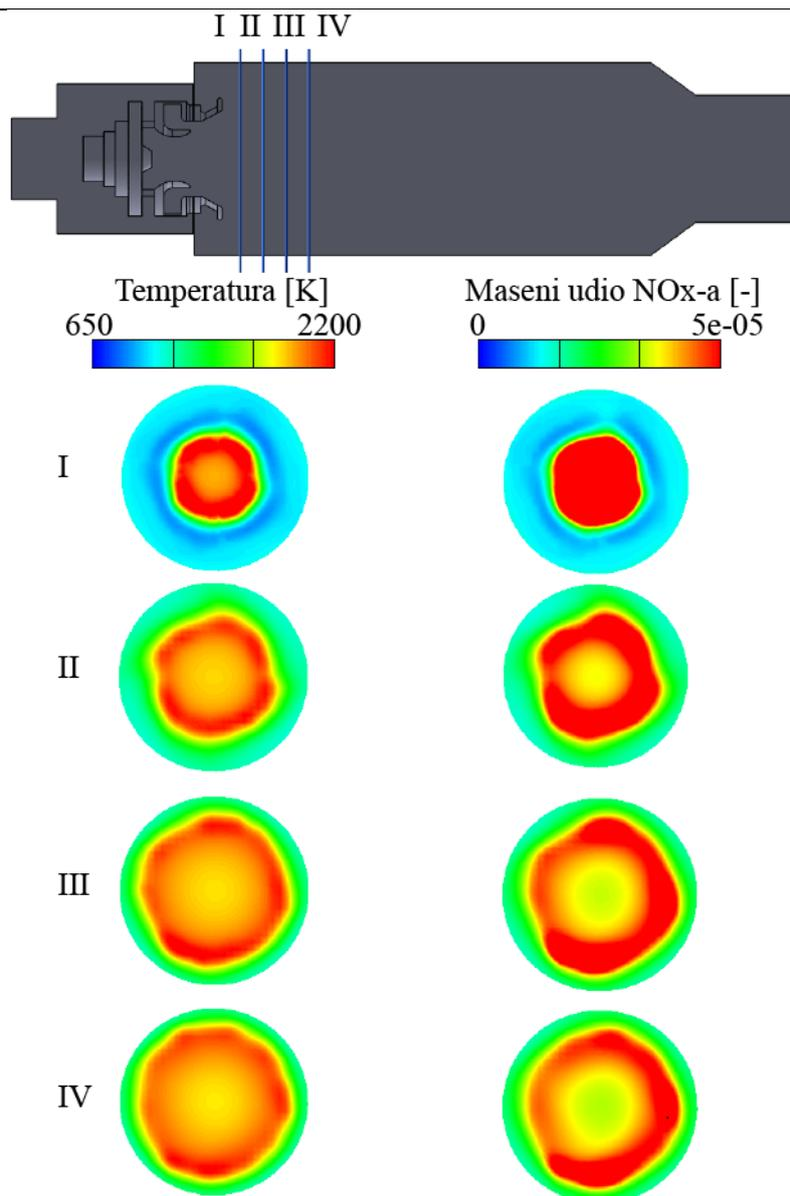
**Slika 10** Temperaturna raspodjela i raspodjela NO<sub>x</sub>-a na različitim udaljenostima u smjeru strujanja zraka
