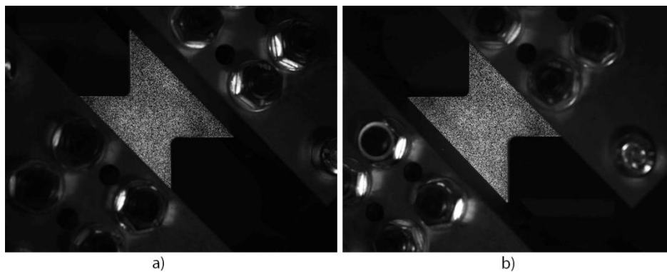
Slika 6.8. Slika postavljenog ispitnog uzorka za ispitivanje kombiniranog vlačnog i smičnog opterećenja sa: a) lijeve kamere, b) desne kamere
