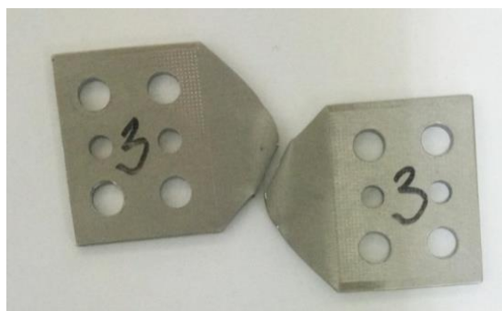
Slika 7.8. Deformirani ispitni uzorak uslijed smičnog opterećenja
