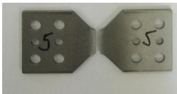
Slika 7.4. Deformirani ispitni uzorak uslijed vlačnog opterećenja
