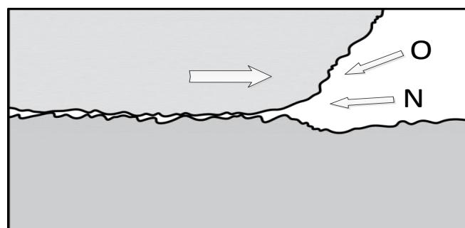
Slika 12. Oksidacijsko trošenje [5]
