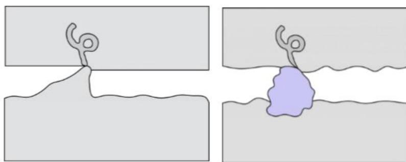
Slika 9. Podjela abrazijskog trošenja ovisno o strukturi tribosustava [5]
