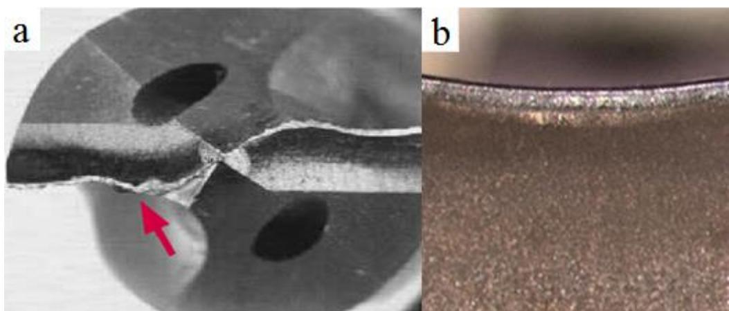
Slika 14. Trošenje stražnje površine glavne rezne oštice a) prema [22], b) prema [23]
