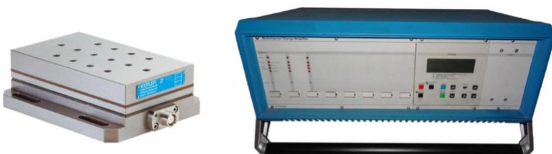
Slika 44. Senzor sila i pripadajuće nabojsno pojačalo [33]
