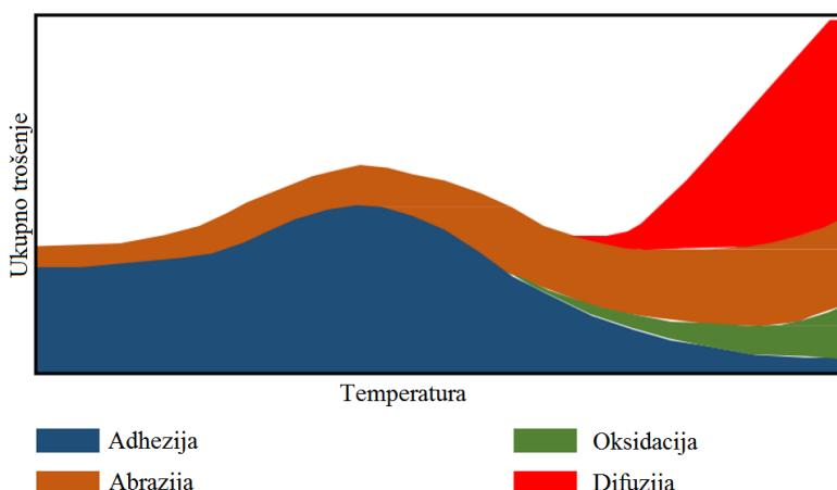
Slika 7. Udjeli procesa trošenja u ukupnom trošenju [18]
