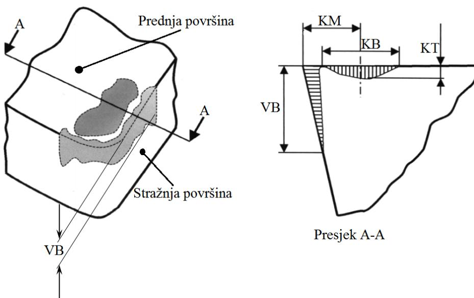
Slika 6. Parametri trošenja oštice reznog alata [19]
