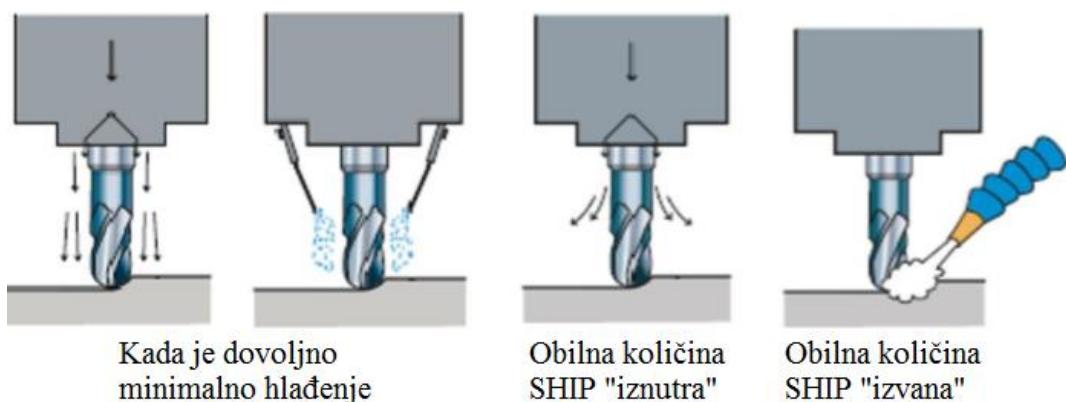
Slika 26. Primjer dovodenja i primjena SHIP-a [27]
