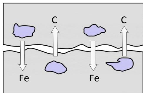
Slika 11. Difuzijsko trošenje [5]
