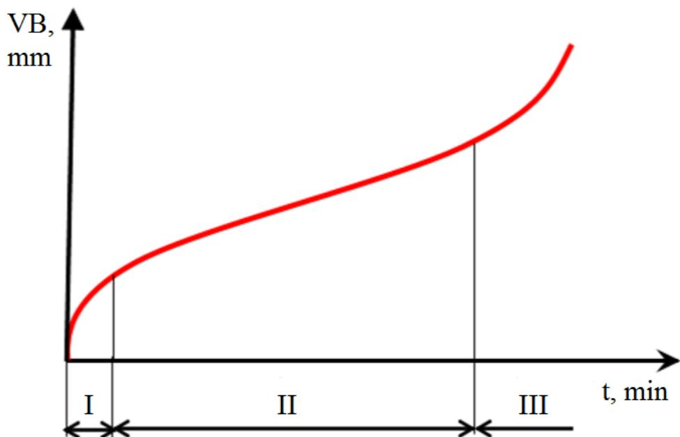
Slika 5. Tipska krivulja trošenja reznih alata [18]
