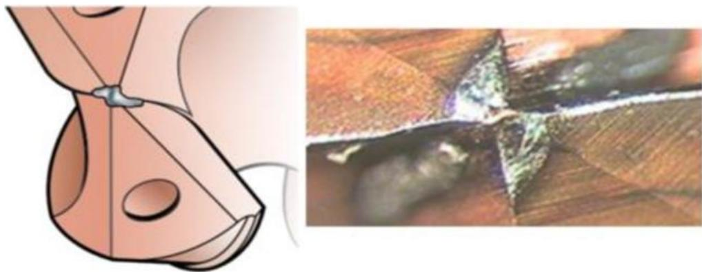
Slika 15. Trošenje stražnje površine poprečne oštice [12]
