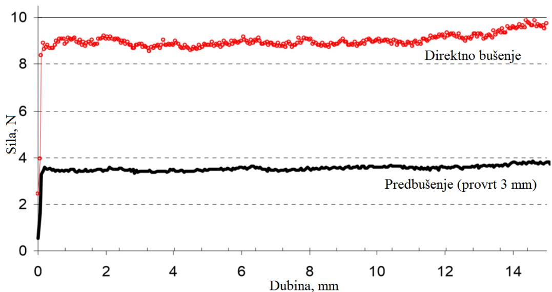
Slika 27. Ovisnost sile o dubini bušenja – sa i bez predbušenja [28]
