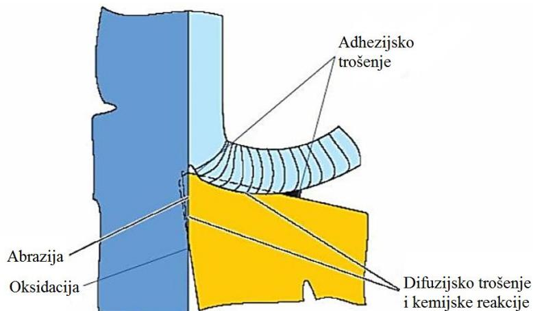
**Slika 8. Mehanizmi trošenja na alatu tijekom obrade [12]**
