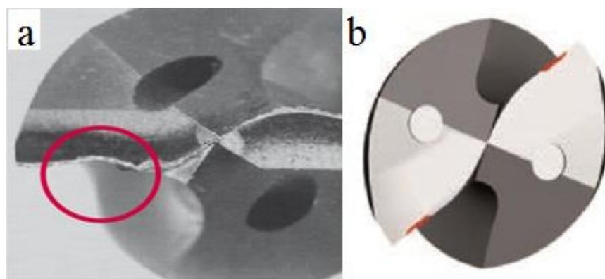
Slika 18. Lom na glavnoj reznoj oštrici a) prema [22], b) prema [24]
