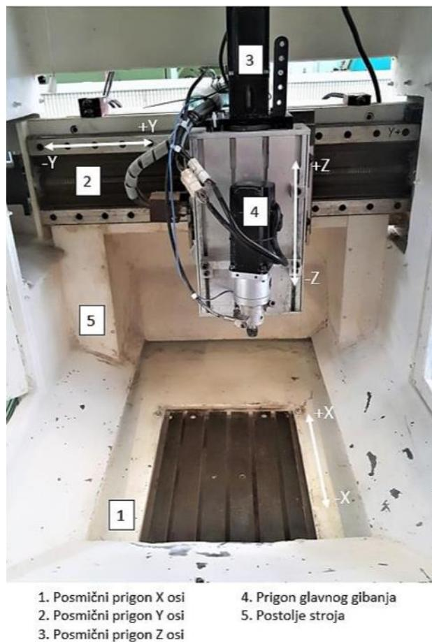
**Slika 40. Prikaz unutrašnjosti tro – osne glodalice [12]**
