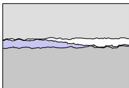
Slika 10. Adhezijsko trošenje [5]
