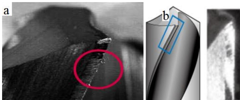
Slika 21. Trošenje fazete svrdla a) prema [22], b) prema [26]
