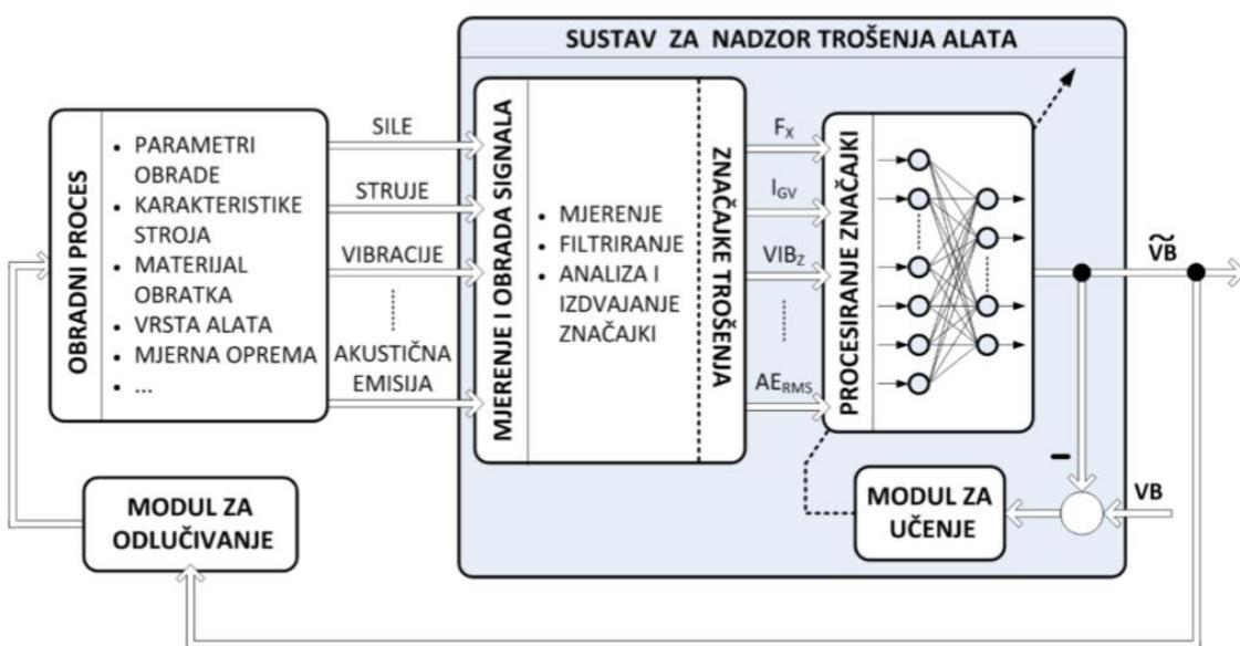
Slika 34. Shematski prikaz sustava nadzora istrošenosti reznog alat [33]
