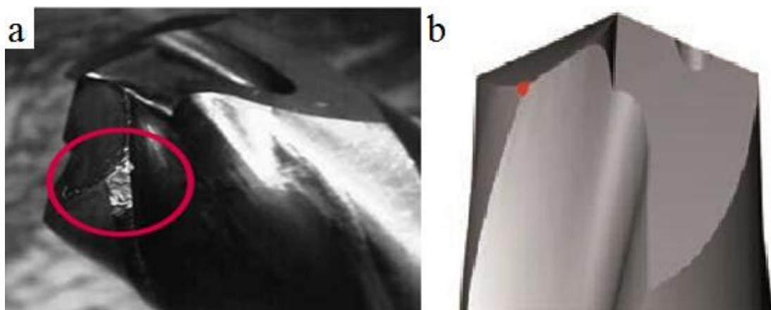
Slika 19. Lom vrha rezne oštice lijevo a) prema [22], b) prema [24]
