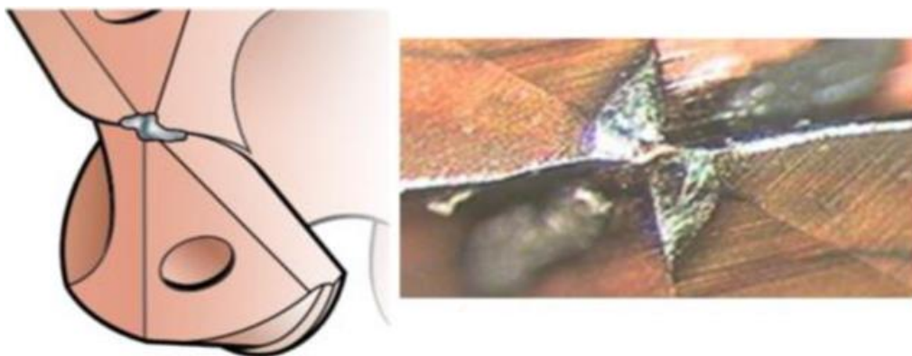
Slika 15. Trošenje stražnje površine poprečne oštrice [12]
