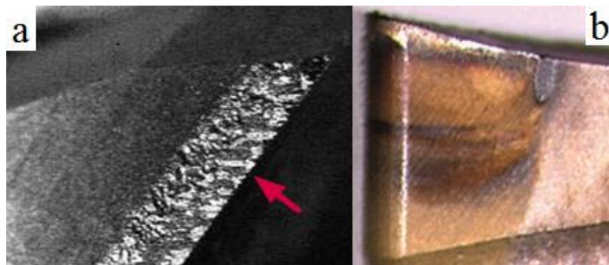
Slika 17. Zarezno trošenje a) prema [22], b) prema [23]
