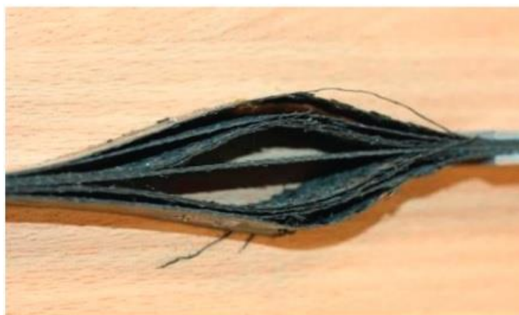
Slika 2. Delaminacija kompozita uslijed vlačnog ispitivanja [3]
