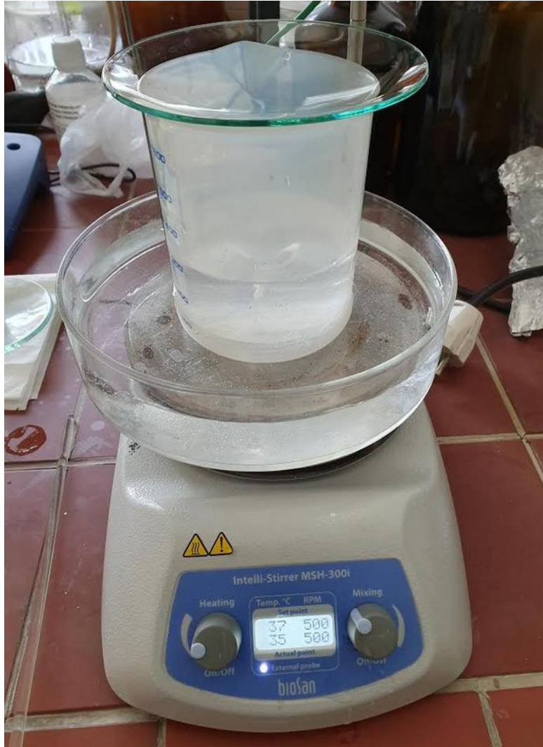
Slika 16 Fotografija magnetske miješalice tijekom zagrijavanja SBF otopine.
