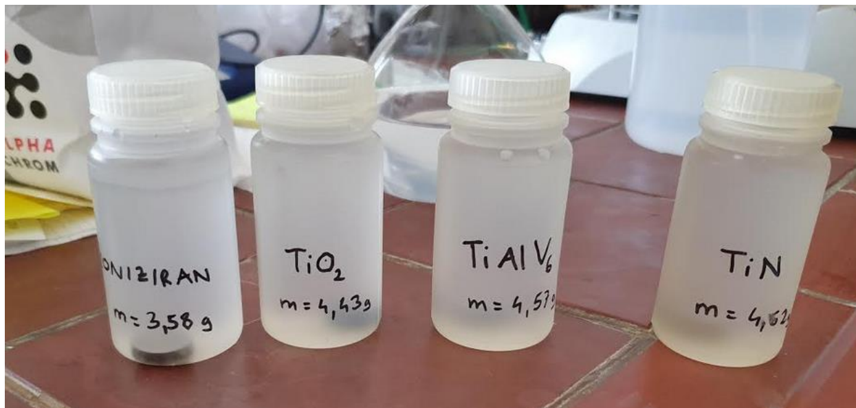
Slika 17 Fotografija uzoraka uronjenih u SBF u polietilenskim bočicama.
