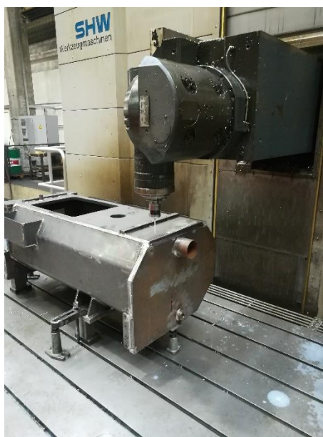
Slika 30. Mjerenje visine ticalom
