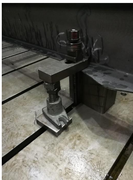
Slika 25. Poluga sa steznim vijkom
