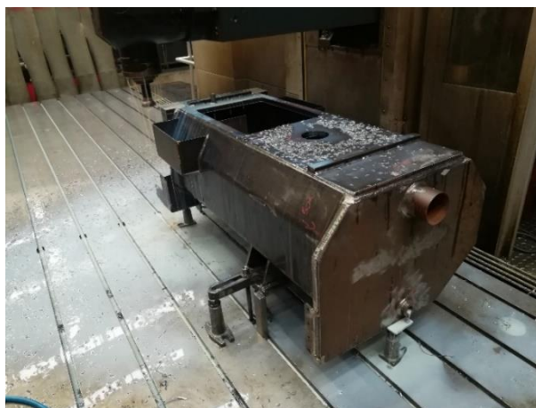
Slika 33. Primjer obrade glodanjem
