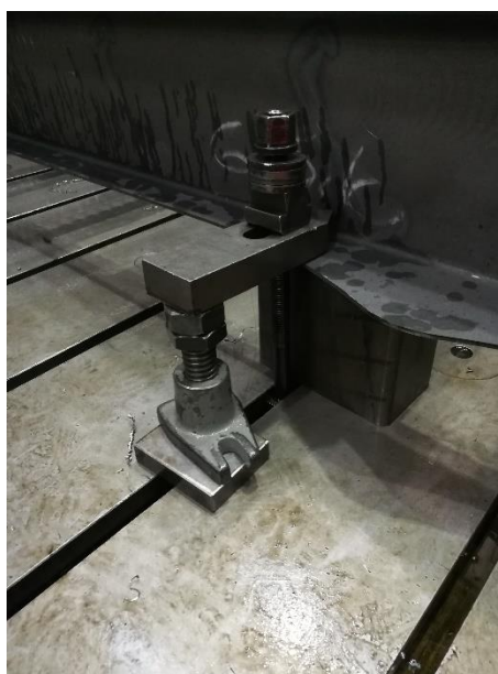
Slika 25. Poluga sa steznim vijkom
