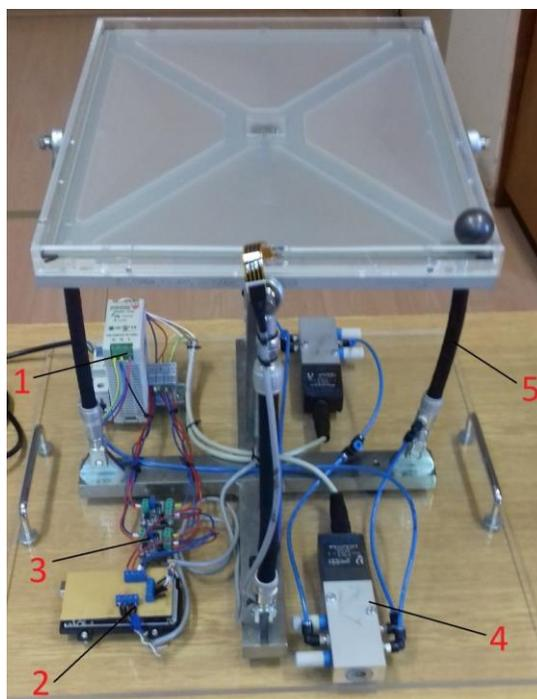
**Slika 11 - Prikaz osnovnih dijelova upravljačkog sustava. Električne komponente: 1 - ispravljač napona, 2 - Arduino Mega 2560, 3 - pretvornik PWM signala u napon. Pneumatske komponente: 4 - proporcionalni pneumatski razvodnik, 5 - pneumatski mišić**
