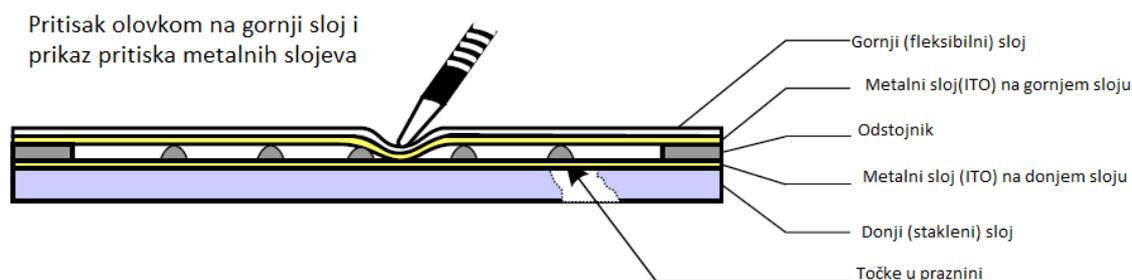
Slika 22 - Prikaz građe zaslona osjetljivog na dodir
