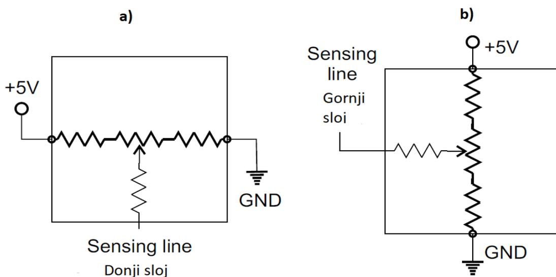
Slika 23 - Shematski prikaz : a) kruga za očitavanje X pozicije , b) kruga za očitavanje Y pozicije
