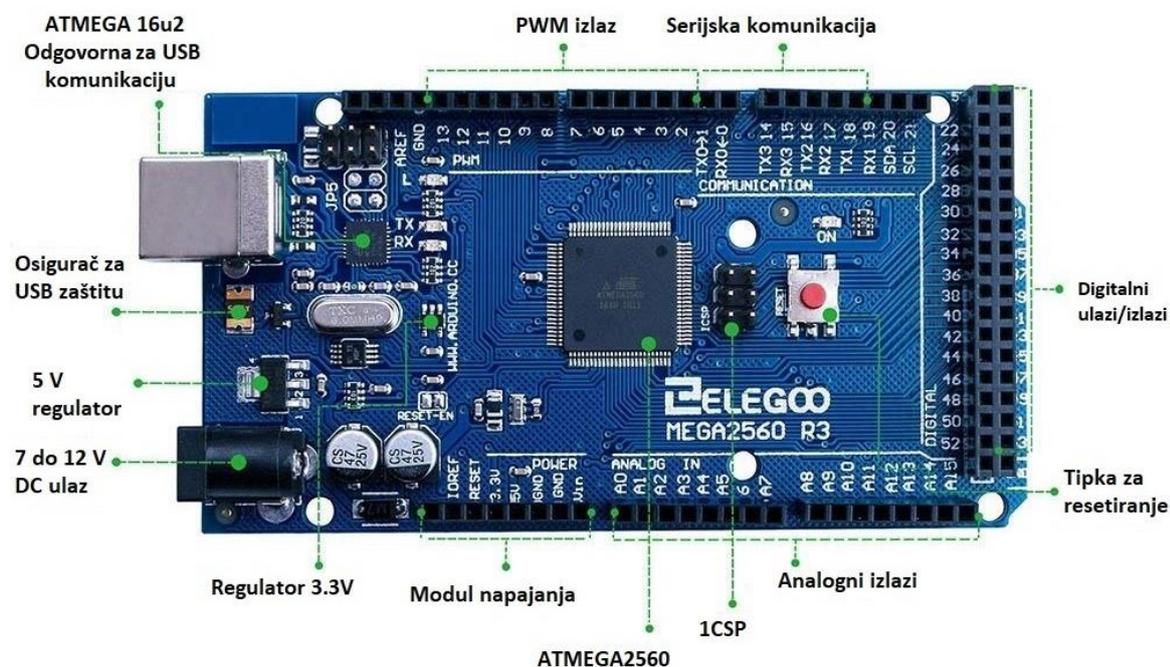
Slika 12 - Mikrokontroler Arduino Mega 2560 sa svojim osnovnim dijelovima
