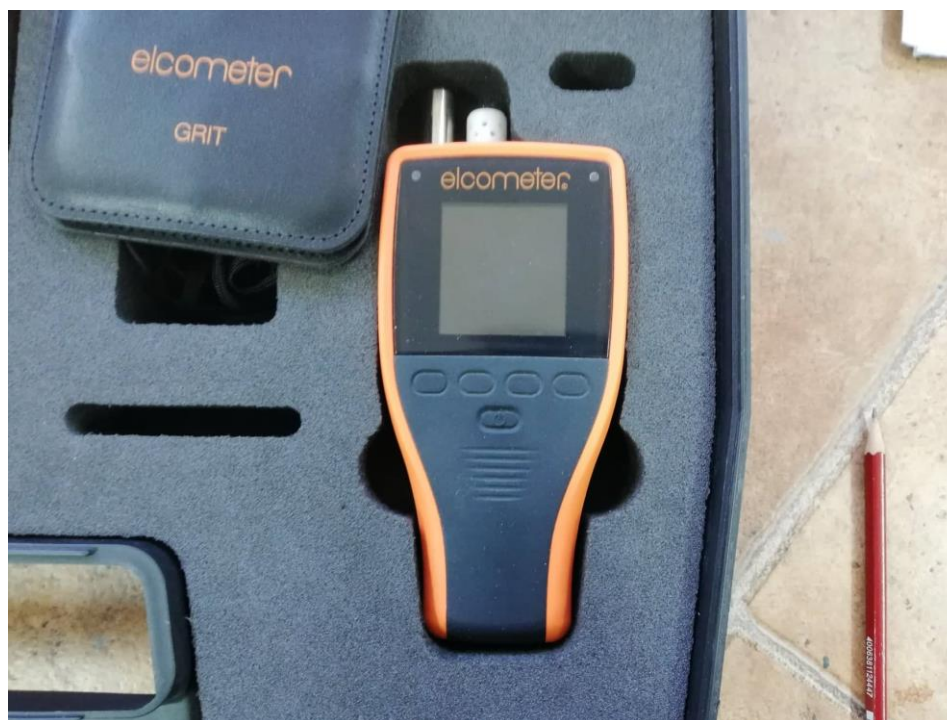
Slika 27 Elcometer 456, uređaj za mjerenje debljine sloja zaštitne prevlake
