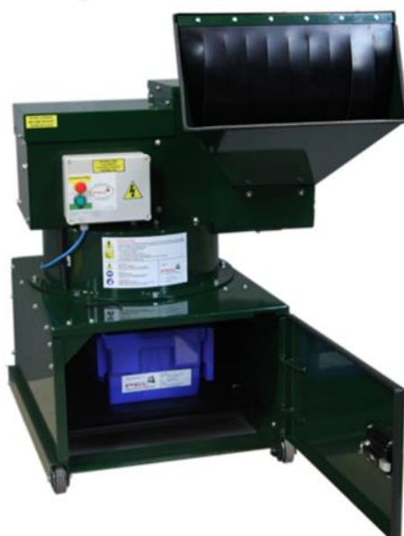
Slika 28. BBO3 'JAWS' drobilica tvrtke Interseroh [34]
