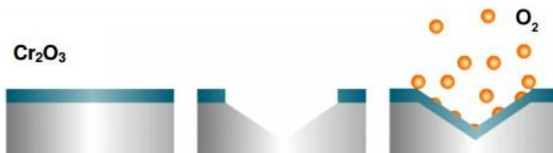
Slika 7. Samoobnavljanje pasivnog filma kromovih oksida na nehrđajućem čeliku [10]
