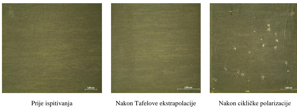
Slika 66. Stereomikroskopske snimke površine uzorka čelika AISI 316L tijekom elektrokemijskih ispitivanja u 3,5 % otopini NaCl s dodatkom H 2 O 2
