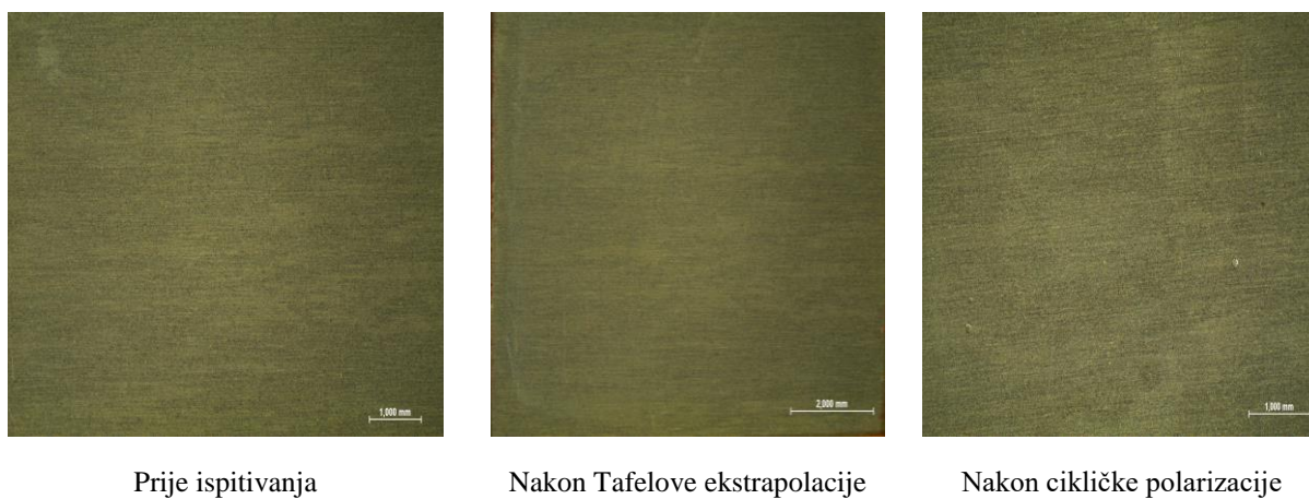
Slika 65. Stereomikroskopske snimke površine uzorka čelika AISI 316L tijekom elektrokemijskih ispitivanja u 3,5 % otopini NaCl
