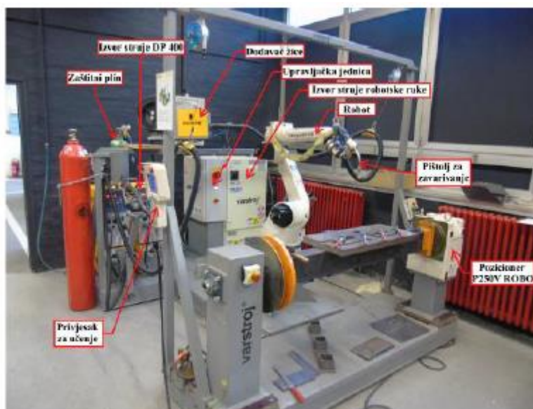
Slika 29. Robotska stanica Almega OTC AX V6 [36]
