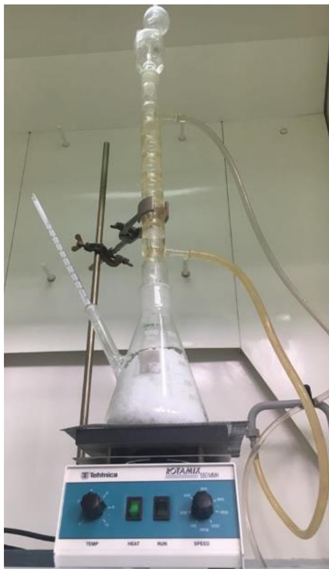
Slika 45. Smjesa magnezijevog klorida i destilirane vode na početku zagrijavanja
