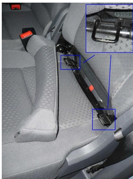
Slika 19 Isofix pričvršna mjesta na šasiji vozila [14]
