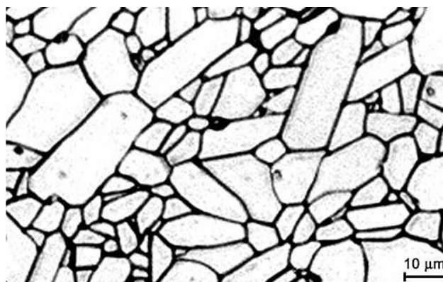
Slika 10. Mikrostruktura \text{Al}_2\text{O}_3 keramike (99,7 %) [8]
