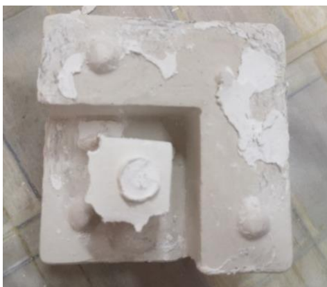
Slika 27. Otvaranje gipsanih kalupa te čišćenje sirovaca
