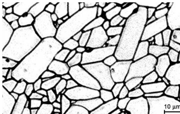
Slika 10. Mikrostruktura \text{Al}_2\text{O}_3 keramike (99,7 %) [8]
