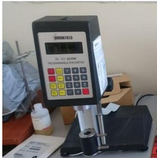
Slika 23. Shematski prikaz rotacijskog viskozimetra Brookfield DV- III Ultra [19]
