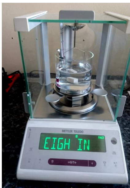
Slika 36. Mjerenje mase uzoraka \text{Al}_2\text{O}_3 u vodi
