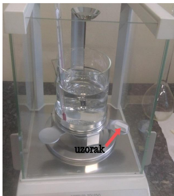
Slika 35. Mjerenje mase uzorka na zraku
