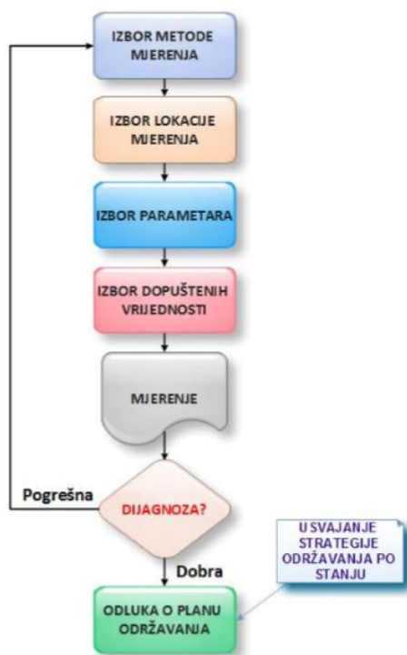
Slika 2. Postupak uvođenja održavanja po stanju kontrolom parametra [2]
