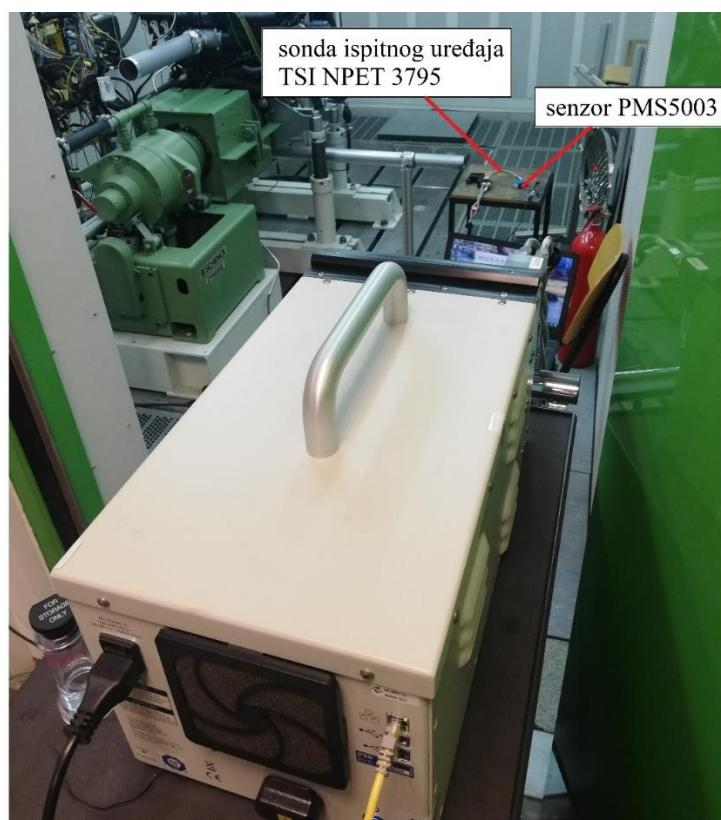
Slika 38. Ispitni uređaj za usporedno mjerena lebdećih čestica
