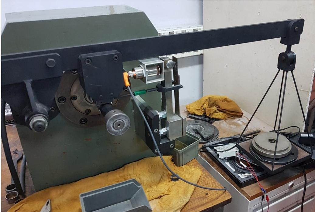
**Slika 22 Uređaj za ispitivanje adhezijskog trošenja**
