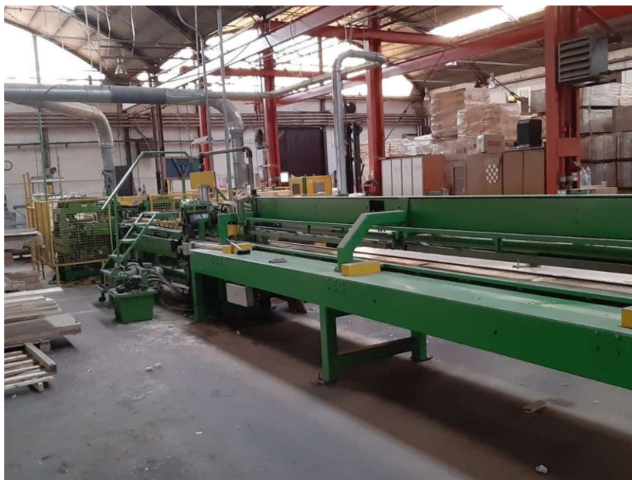
Slika 6-8 Stroj za izradu dužinskih lamela s cink-spojem
