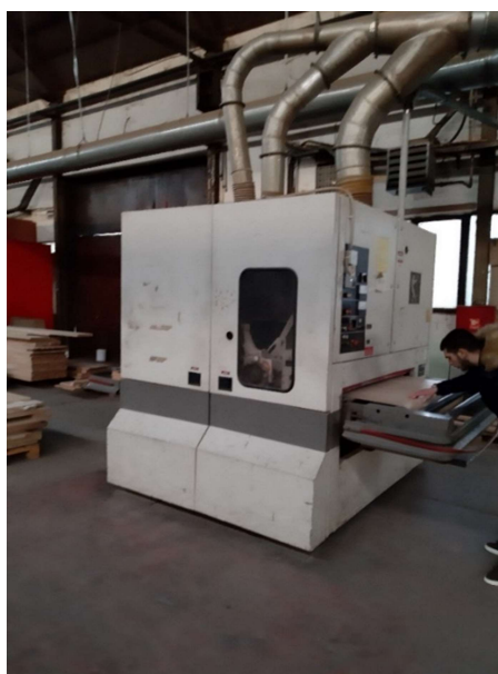
Slika 6-12 Stroj za dvostrano blanjanje ploča
