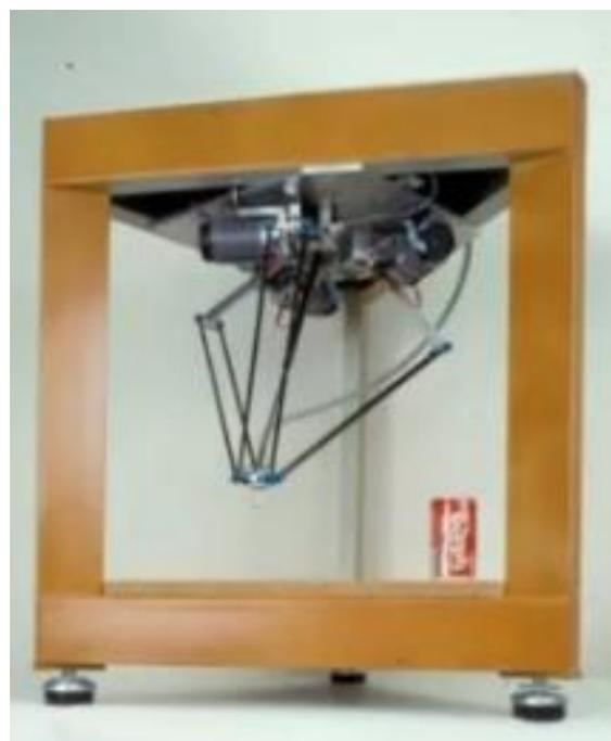
Slika 2. Prvi prototip delta robota (siječanj 1986)
