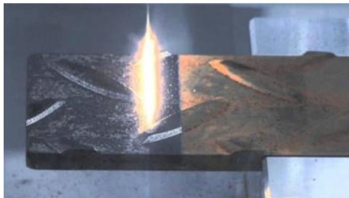
Slika 4.2 Čišćenje laserskom zrakom [9]
