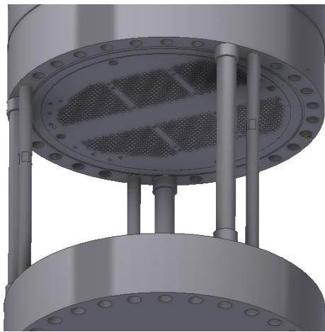
**Slika 14. Odvojene i oslonjene prirubnice s omogućenim pristupom cijevnoj stijeni**
