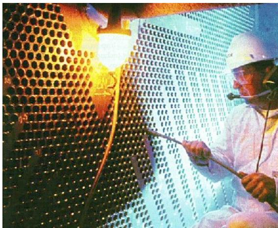
Slika 7. Ručno ispitivanje cijevne stijene [10]
