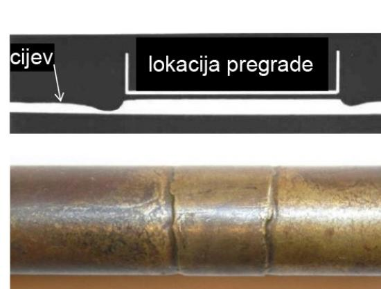
Slika 10. Oštećenja cijevi u neposrednoj blizini pregrade [12]
