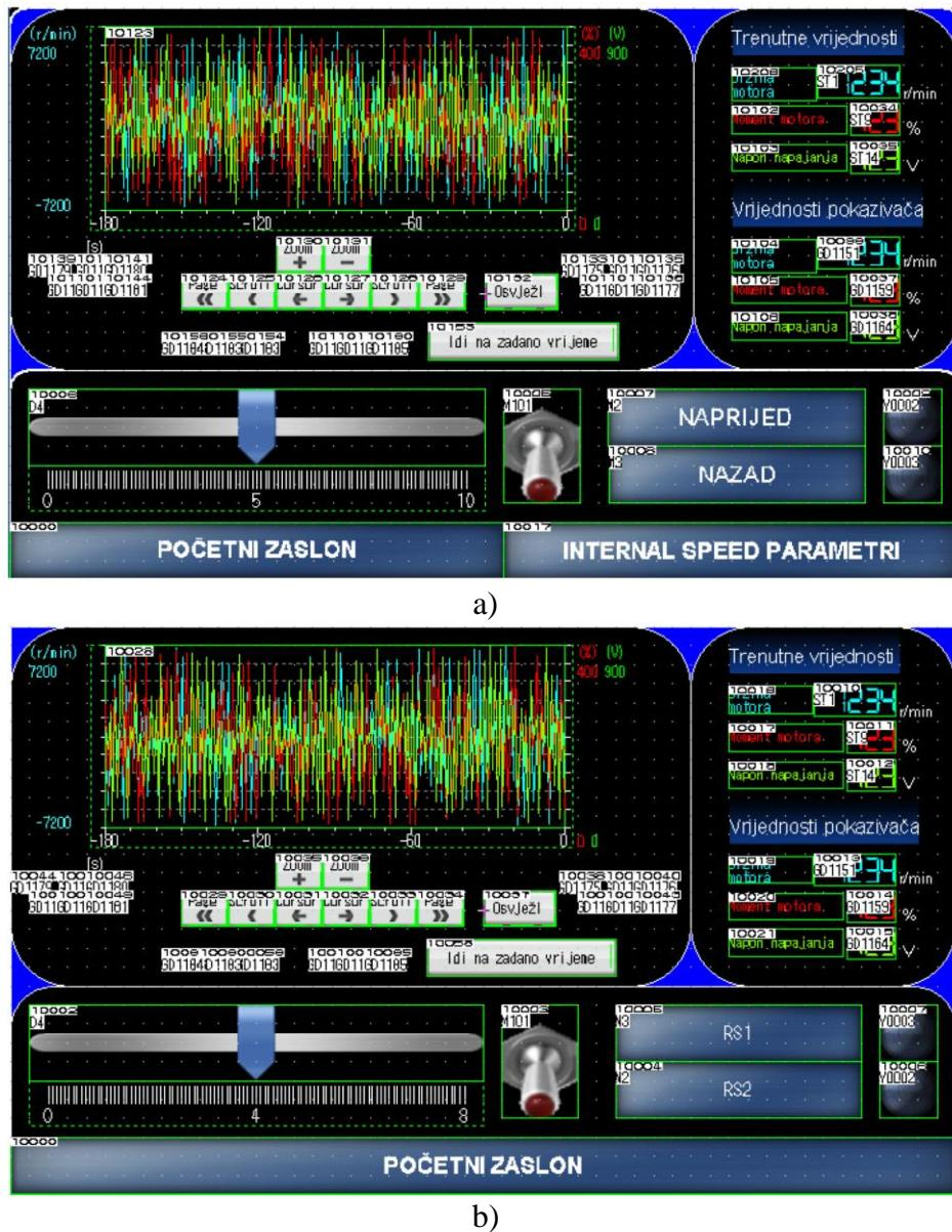
Slika 38. HMI sučelje za regulaciju brzine (a) i regulaciju momenta (b) [9]
