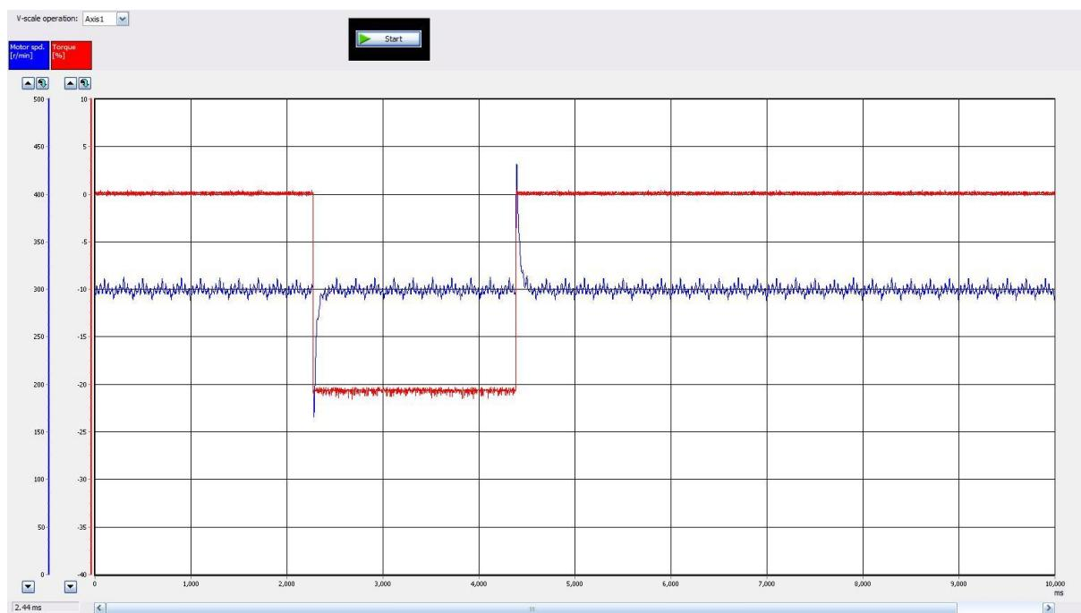
Slika 53. Mjerenje odziva pri 20% nazivnog momenta i 300 o/min
