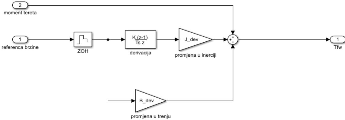
Slika 25. Model predkompenzatora u programskom paketu Simulink
