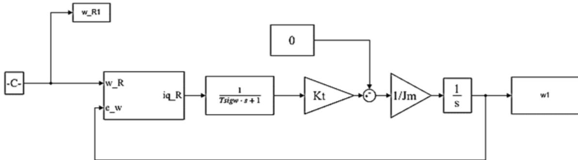
Slika 16. Pojednostavljeni model brzine vrtnje uz PI regulator
