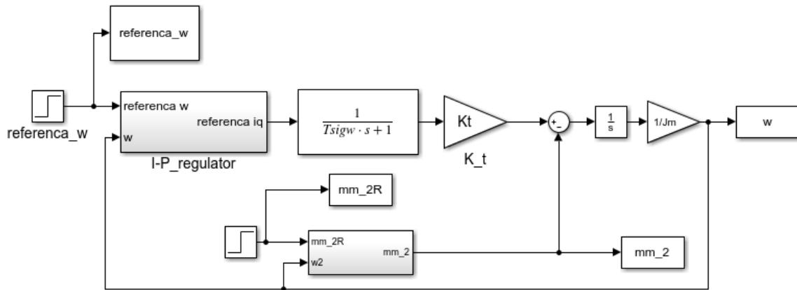
Slika 39. Simulacijski model eksperimentalnog postava u Simulink-u
