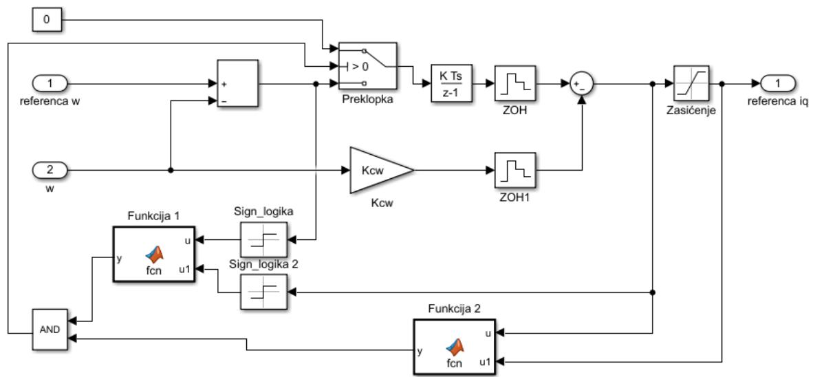
Slika 34. I-P regulator uz implementirani *anti wind-up* mehanizam
