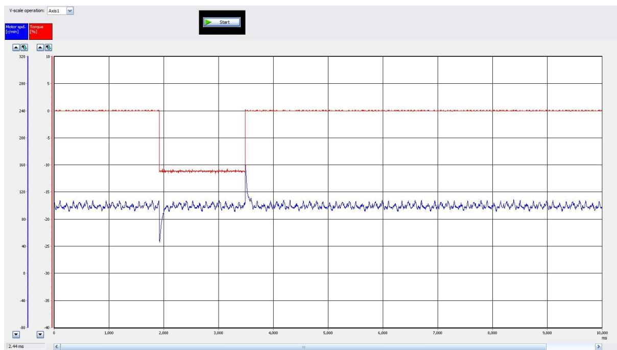
Slika 49. Mjerenje odziva pri 10% nazivnog momenta i 100 o/min
