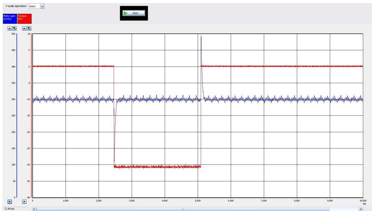
Slika 54. Mjerenje odziva pri 30% nazivnog momenta i 300 o/min
