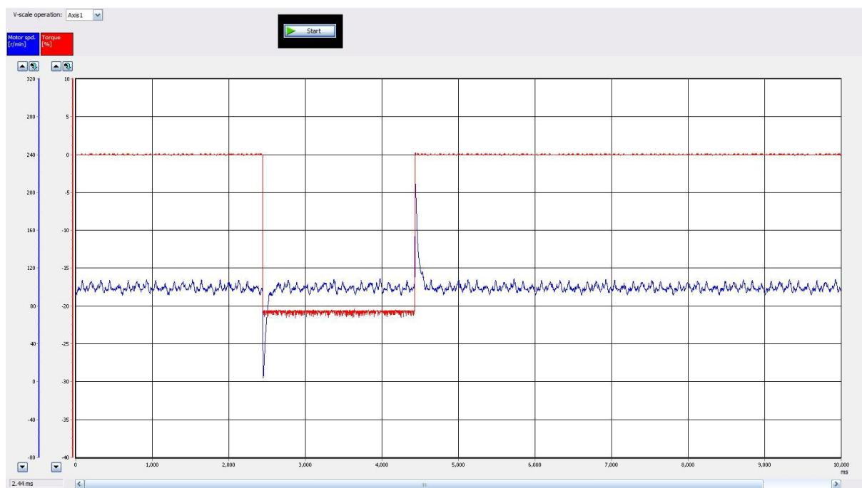
Slika 50. Mjerenje odziva pri 20% nazivnog momenta i 100 o/min
