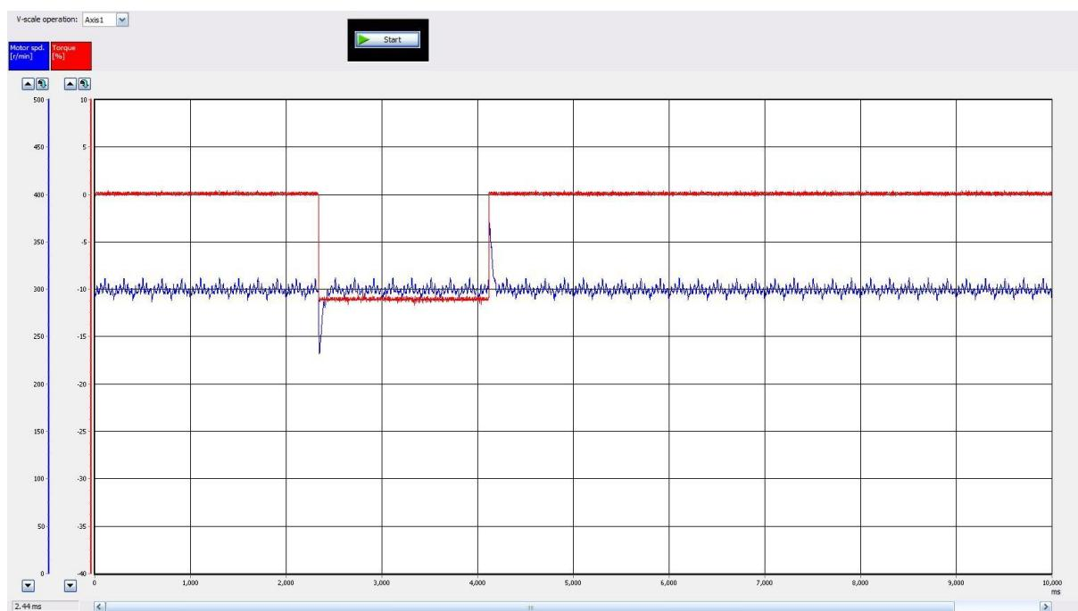
Slika 52. Mjerenje odziva pri 10% nazivnog momenta i 300 o/min
