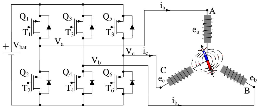
**Slika 9.** Trofazni izmjenjivač spojen na faze električnog motora
