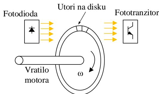
**Slika 6.** Inkrementalni enkoder
