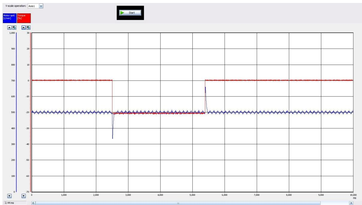
Slika 56. Mjerenje odziva pri 20% nazivnog momenta i 500 o/min
