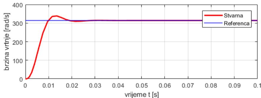
Slika 21. Odziv brzine vrtnje uz karakteristične odnose  $D_{2\omega} = 0.5$  i  $D_{3\omega} = 0.5$
