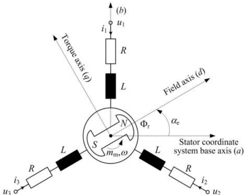
**Slika 10.** Shematski prikaz PMSC motora [11]
