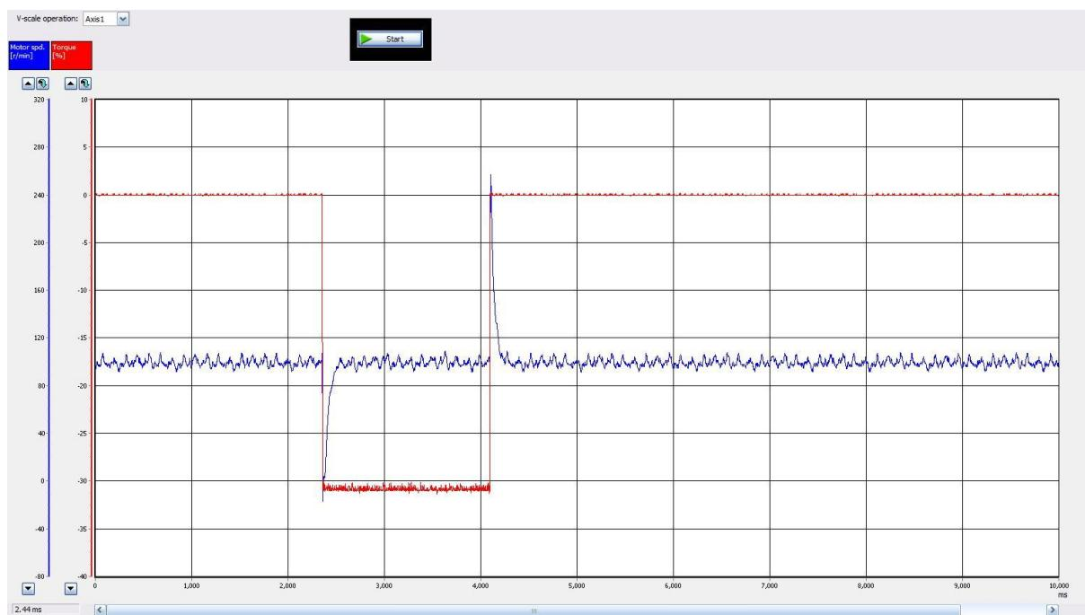
Slika 51. Mjerenje odziva pri 30% nazivnog momenta i 100 o/min
