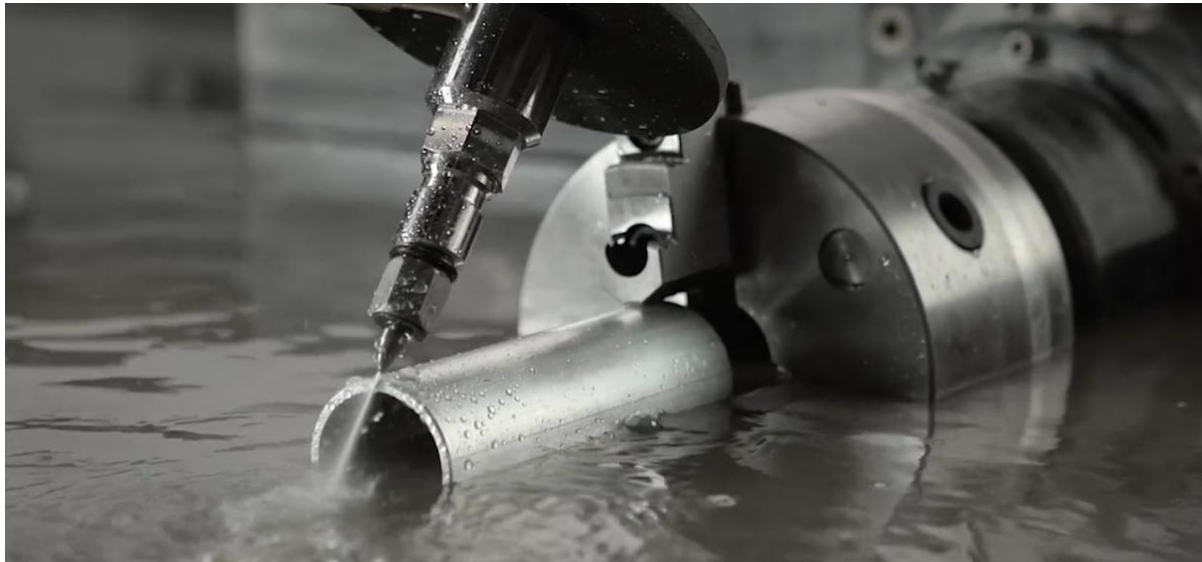
Slika 16. Višeosna AWJM obrada [20]
