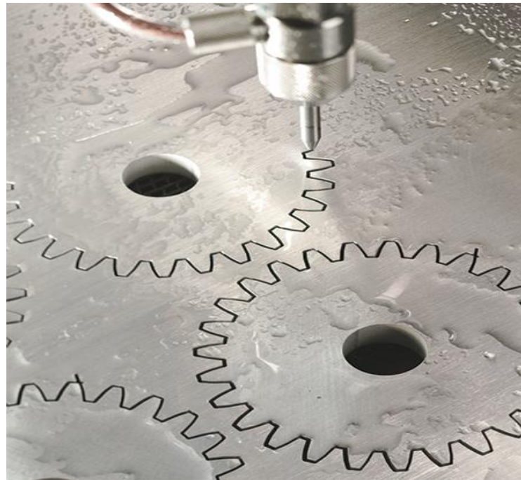
Slika 9. Obrada aluminija vodenim mlazom [14]
