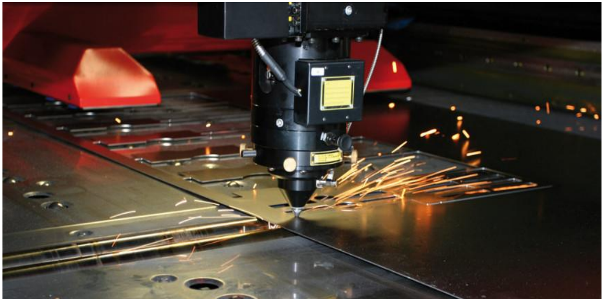
Slika 34. Laserska obrada lima [35]
