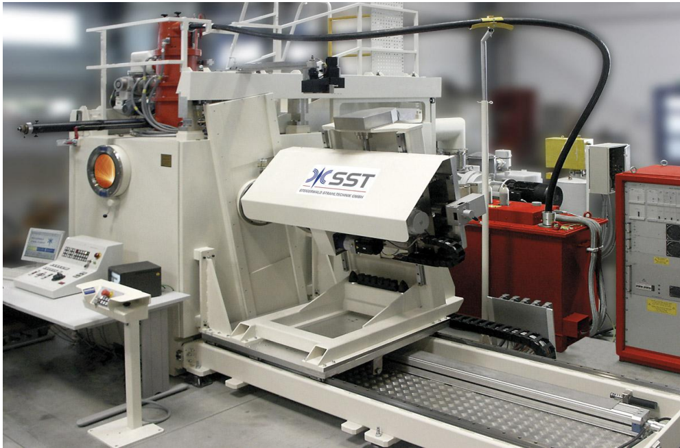
Slika 31. Uređaj za bušenje snopom elektrona [32]
