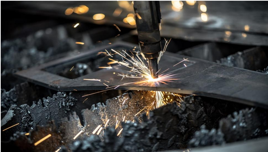
Slika 39. Prikaz rezanja plazmom [31]
