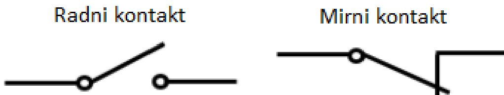
Slika 31: Simbol radnog i mirnog kontakta [7]
