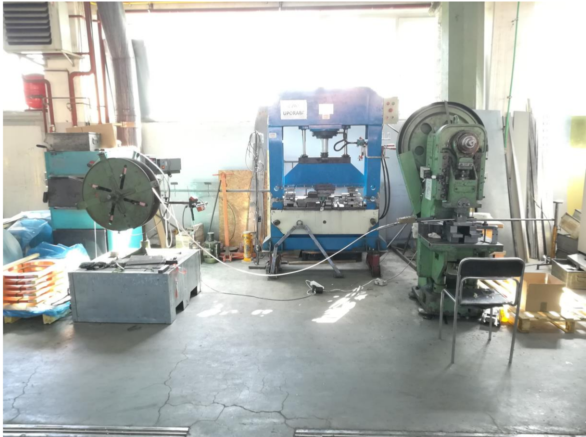
Slika 3. Odmatalica lijevo i ekscentar preša desno
