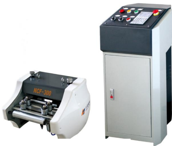
Slika 18. Servo dodavač sa upravljačkim ormarom [15]
