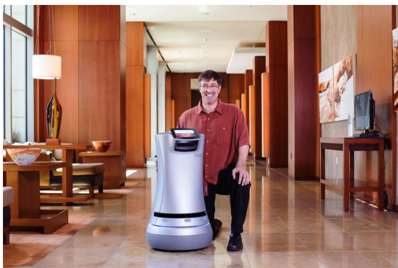
Slika 7. Poslužni mobilni robot tvrtke Savioke Relay [7]
