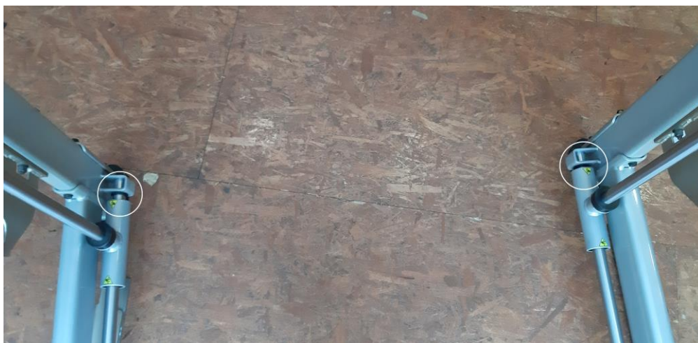
Slika 6.7. Razlog mogućeg zakretanja šipke u horizontalnoj ravnini
