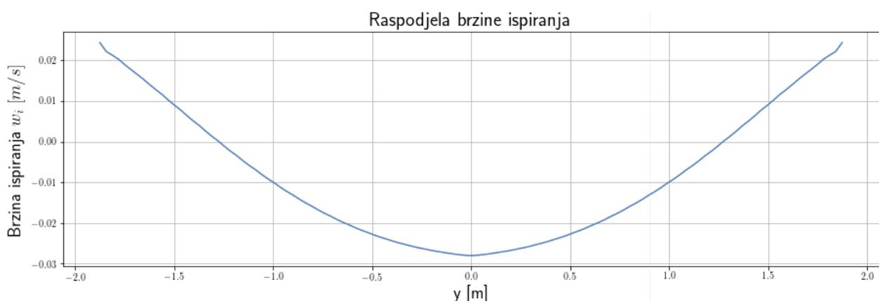
Slika 3.4: Brzina ispiranja ravne PrandtlD geometrije
