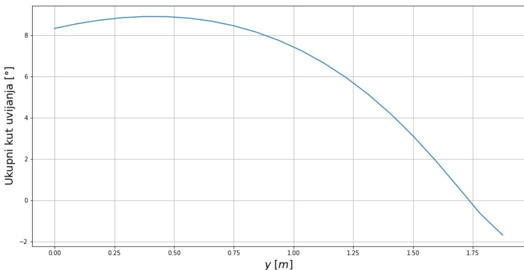
Slika 3.2: Zbroj aerodinamičkog i geometrijskog uvijanja
